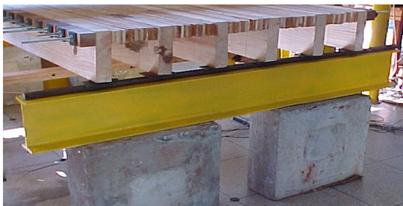
FIGURA 58 - Detalhe do apoio do modelo
