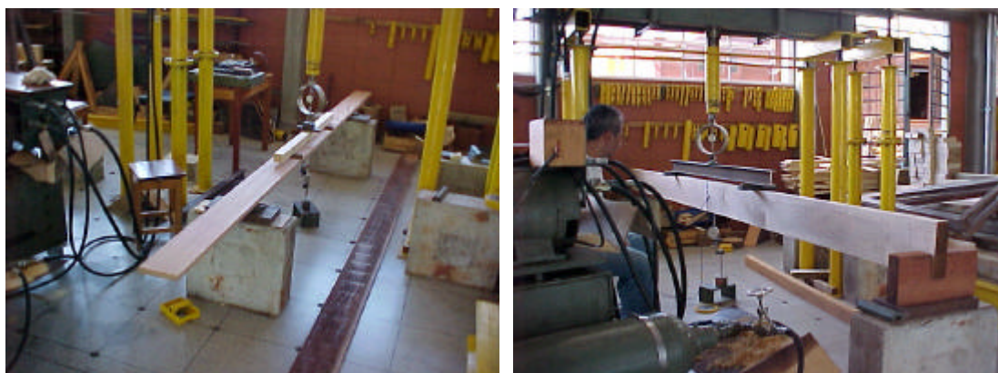
Figura 28 – Ensaio de flexão em peça de mesa (esquerda) e peça de alma (direita).
