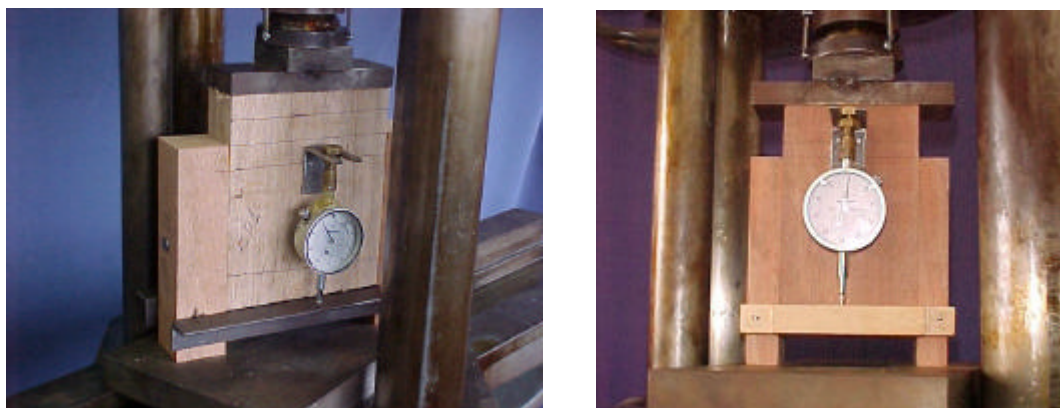
Figura 41 – Configuração do ensaio de ligação para corpo-de-prova tipo 1 e 2.
