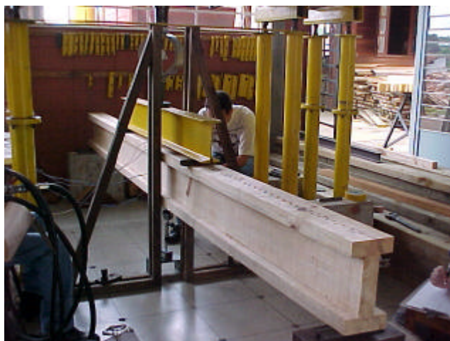
Figura 36 – Viga composta posicionada para ensaio.
