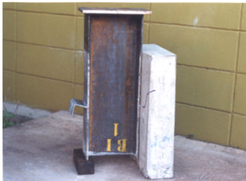
FIGURA 3.7: Rotação do conector junto à ligação com o perfil, modelo ensaiado por MALITE (1993)
