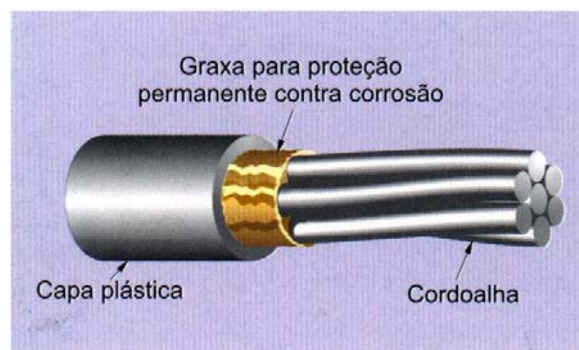
Figura 2.2 – Composição da monocordoalha engraxada
