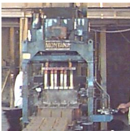
Figura 4.1 - Vista geral da prensa hidropneumática utilizada para confecção dos blocos de concreto com função estrutural
