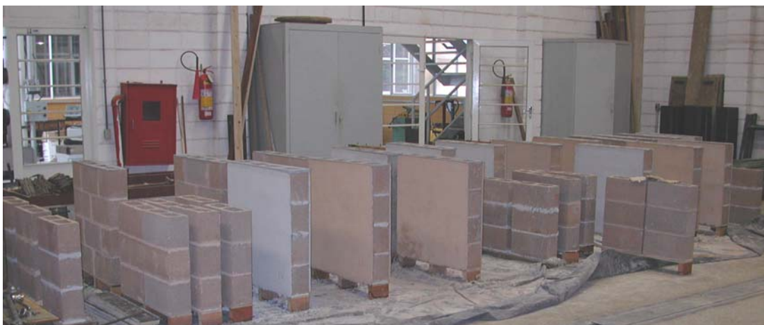
Figura 5.5 - Vista das paredes e prismas de alvenaria
