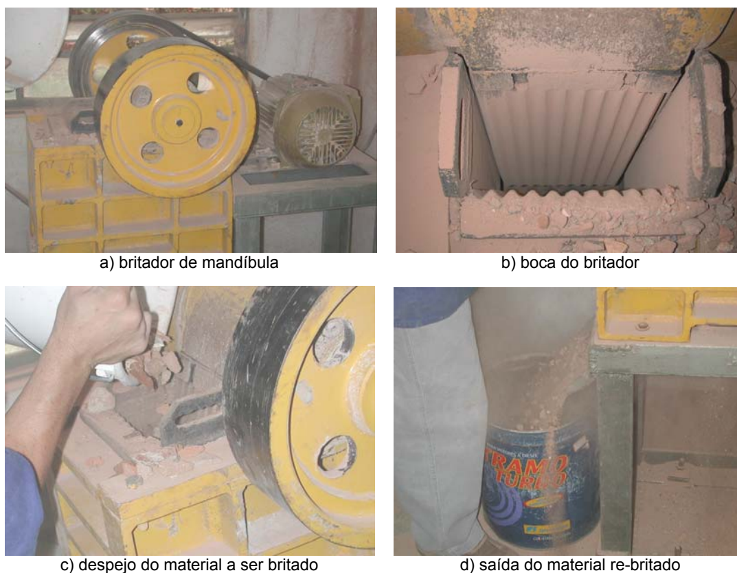
Figura 4.17 - Processo de re-britagem de entulho
