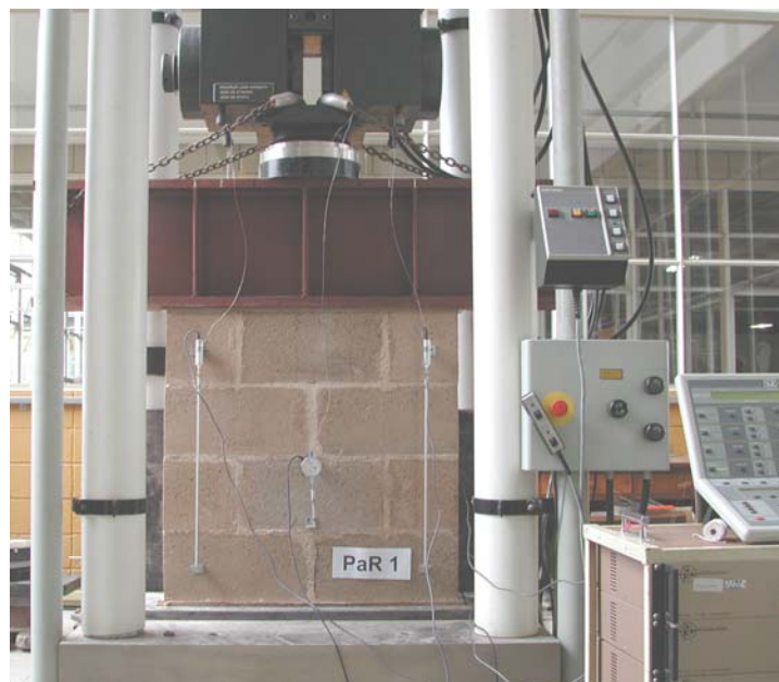
Figura 3.2 - Posicionamento da viga de distribuição na parede de alvenaria instrumentada ao pórtico de reação
