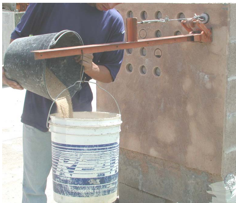
Figura 6.9 - Execução do ensaio de aderência da argamassa
