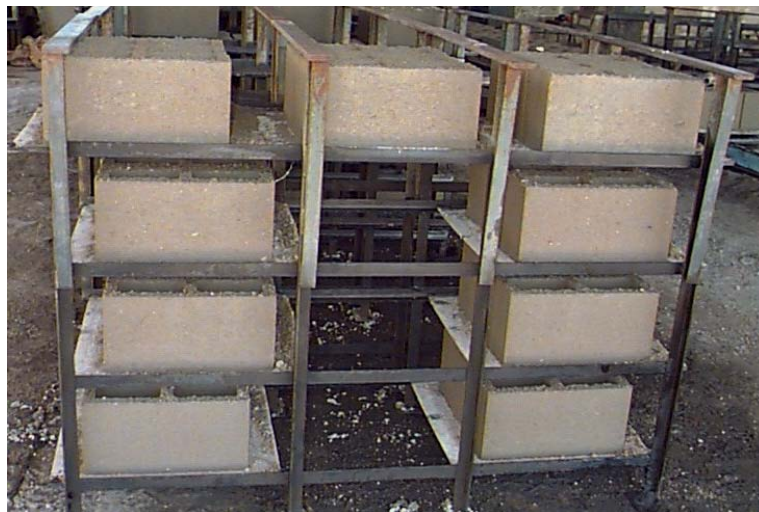
Figura 5.1 - Permanência dos blocos às chapas metálicas por 5 dias
