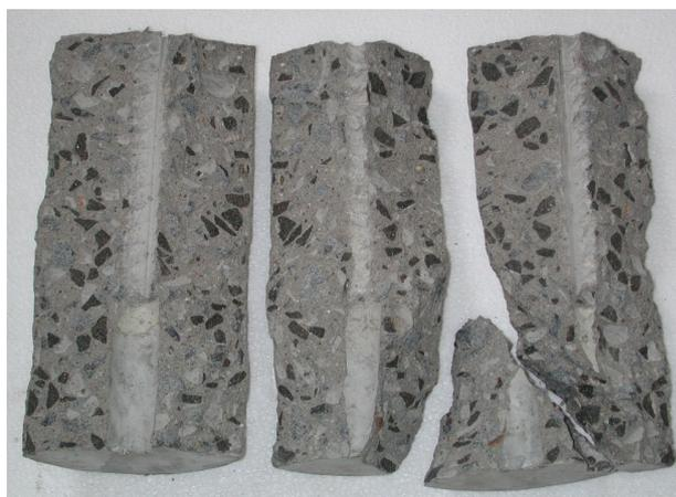
Figura 6.2 – Ruptura por fendilhamento (PT-PILOTO 1)
