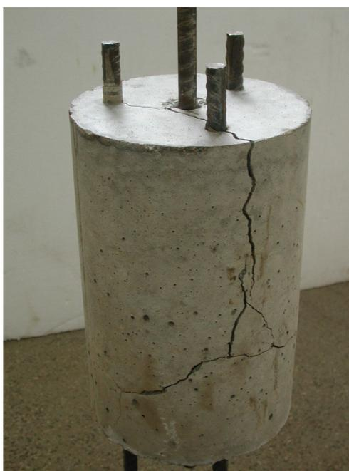
Figura 6.3 - Ruptura por fendilhamento dos modelos do ensaio das quatro barras
