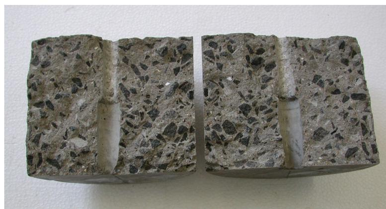
Figura 6.11 - Ruptura por fendilhamento dos modelos da série 12,5
