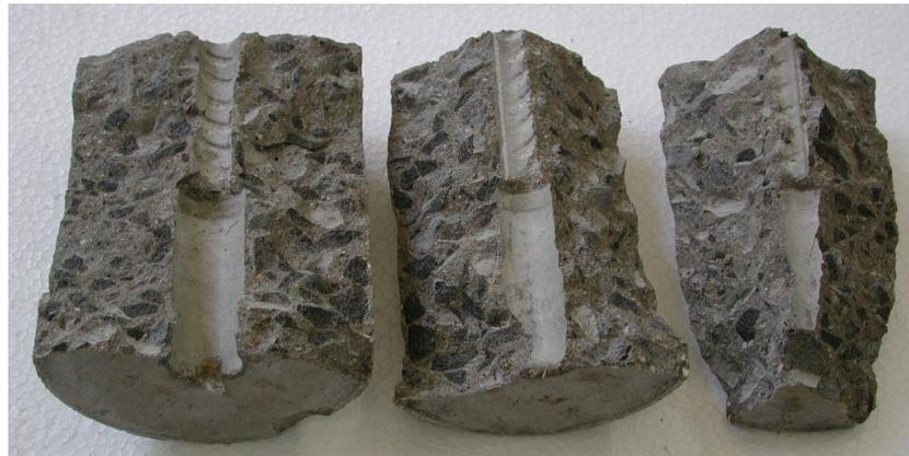
Figura 6.10 - Ruptura por fendilhamento dos modelos da série 7,5
