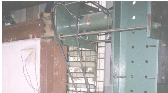
FIGURA 3.8 - Sistema de aplicação de carga (cilindro hidráulico)
