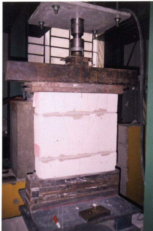
FIGURA 3.18 - Ensaio de prisma à compressão
