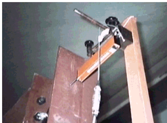
FIGURA 3.11 - Transdutor de deslocamento lateral global
