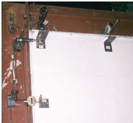
FIGURA 3.13 - Transdutores de deslocamentos horizontal e vertical superiores e relógios comparadores
