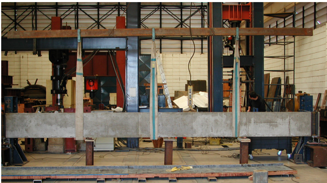
Figura 6.18 – Cintas de içamento igualmente esticadas, presas à viga e ao balancim metálico.
