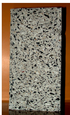
Figura 6.8 – Concreto de granulometria fina: corpo-de-prova 10cmx20cm.
