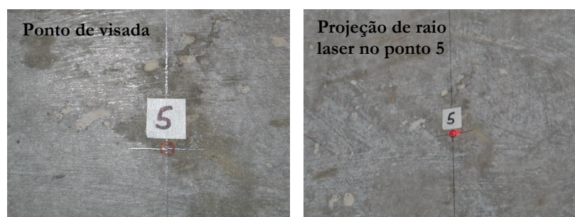
Figura 6.13 – Leitura das coordenadas (x, y, z) do ponto 5 através de raio laser – TCR 705.
