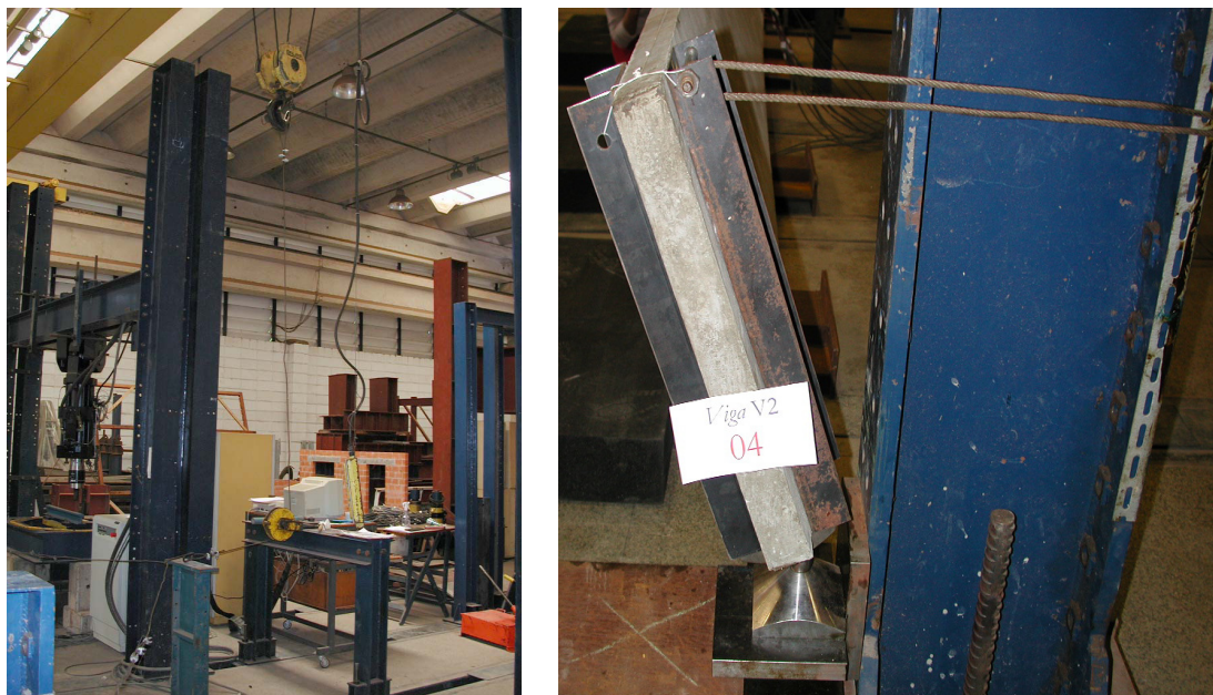
Figura 6.21 –Detalhe (a) da ponte rolante e (b) da fixação do cabo no perfil metálico.
