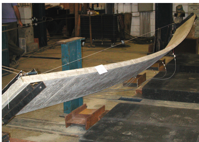
Figura 6.28 – Etapa 10 equivalente à inclinação imposta de 48,86^\circ .
