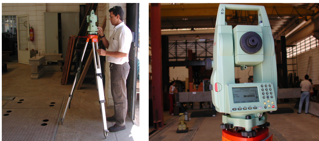
Figura 6.11 – (a) Vista da TCR 705 e (b) Vista da Estação Total e da viga V2 ao fundo.
