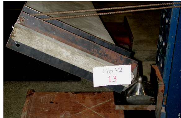
Figura 6.30 – Etapa 13: inclinação imposta de 63,5°.
