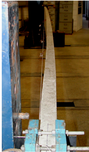
Figura 6.35 – Deformação residual final da viga V1.
