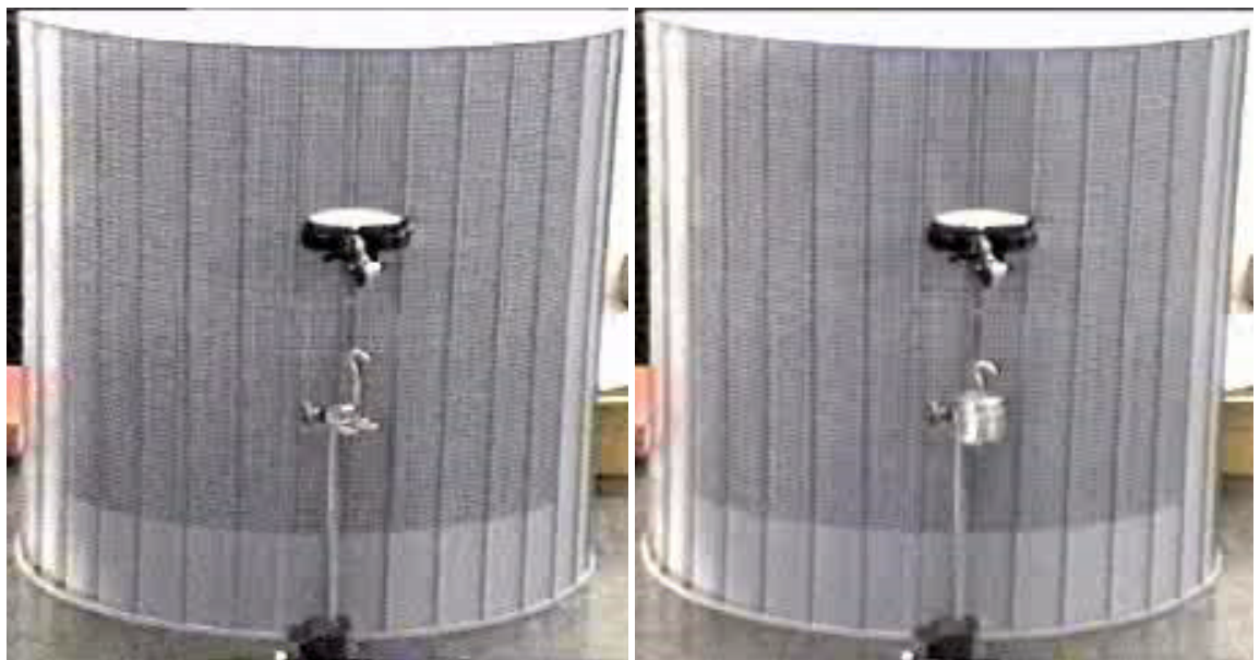
FIGURA 71 – Cilindro indeformado e com força 1,37 N - z = 380 mm, V_2
