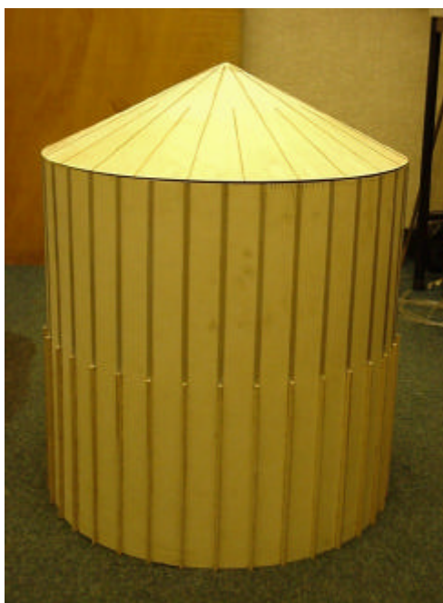
FIGURA 50 – Modelo rígido 1,0 com elementos externos
