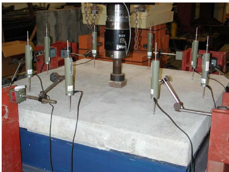
Figura 5.4 – Sistema de ensaio das ligações laje-pilar (a)
