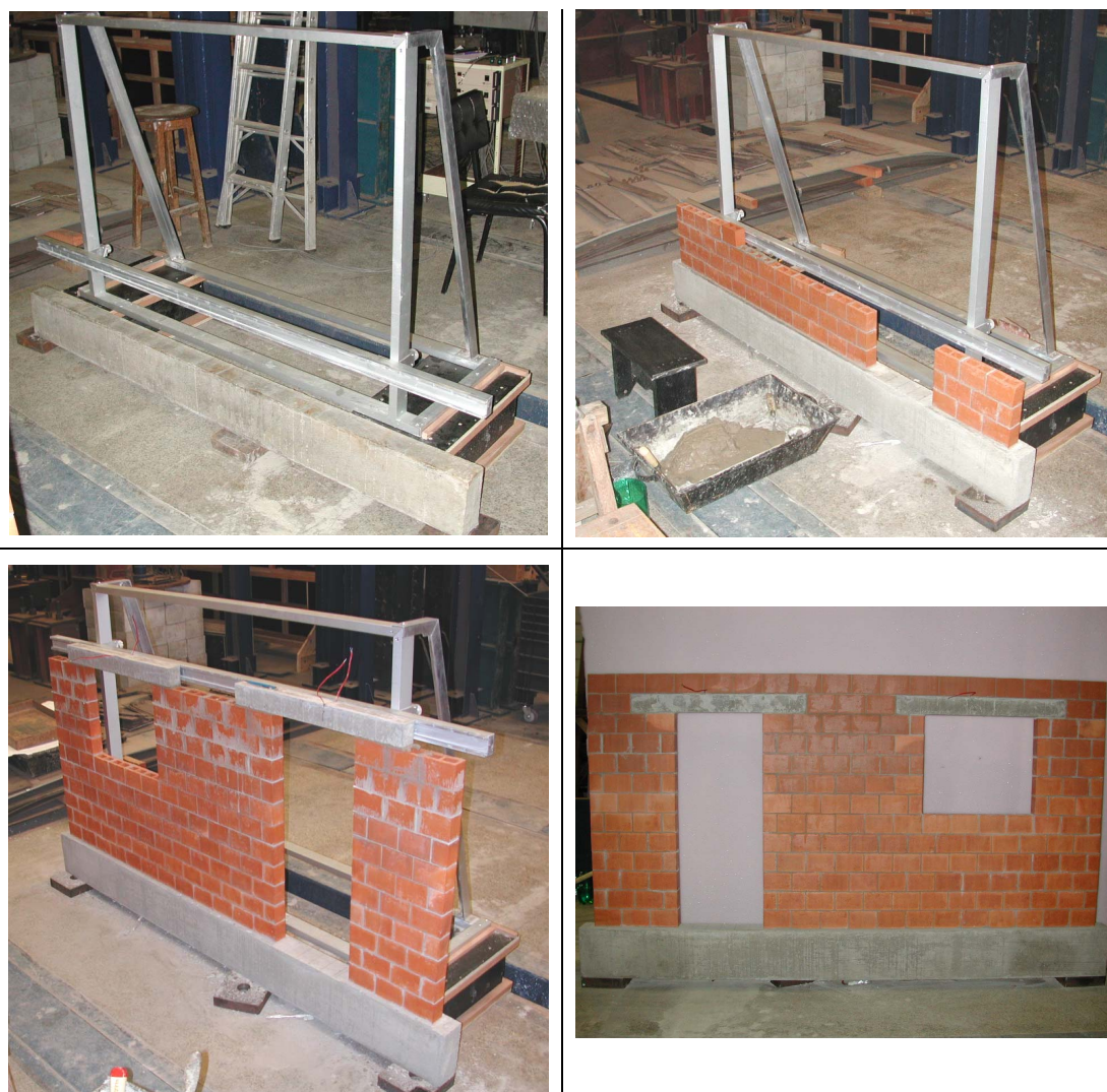
Figura 3.18 Processo de construção dos painéis.
