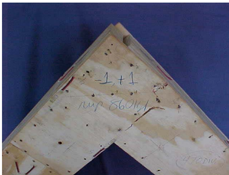
Figura 54 – Modo de ruptura típico dos CPs “-1”
