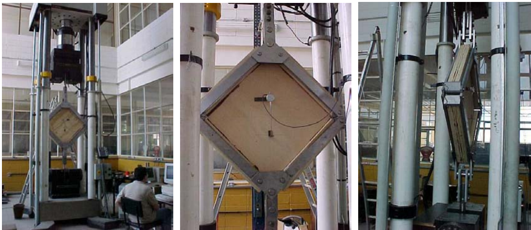
Figura 40 – Corpo-de-prova posicionado para ensaio de cisalhamento
