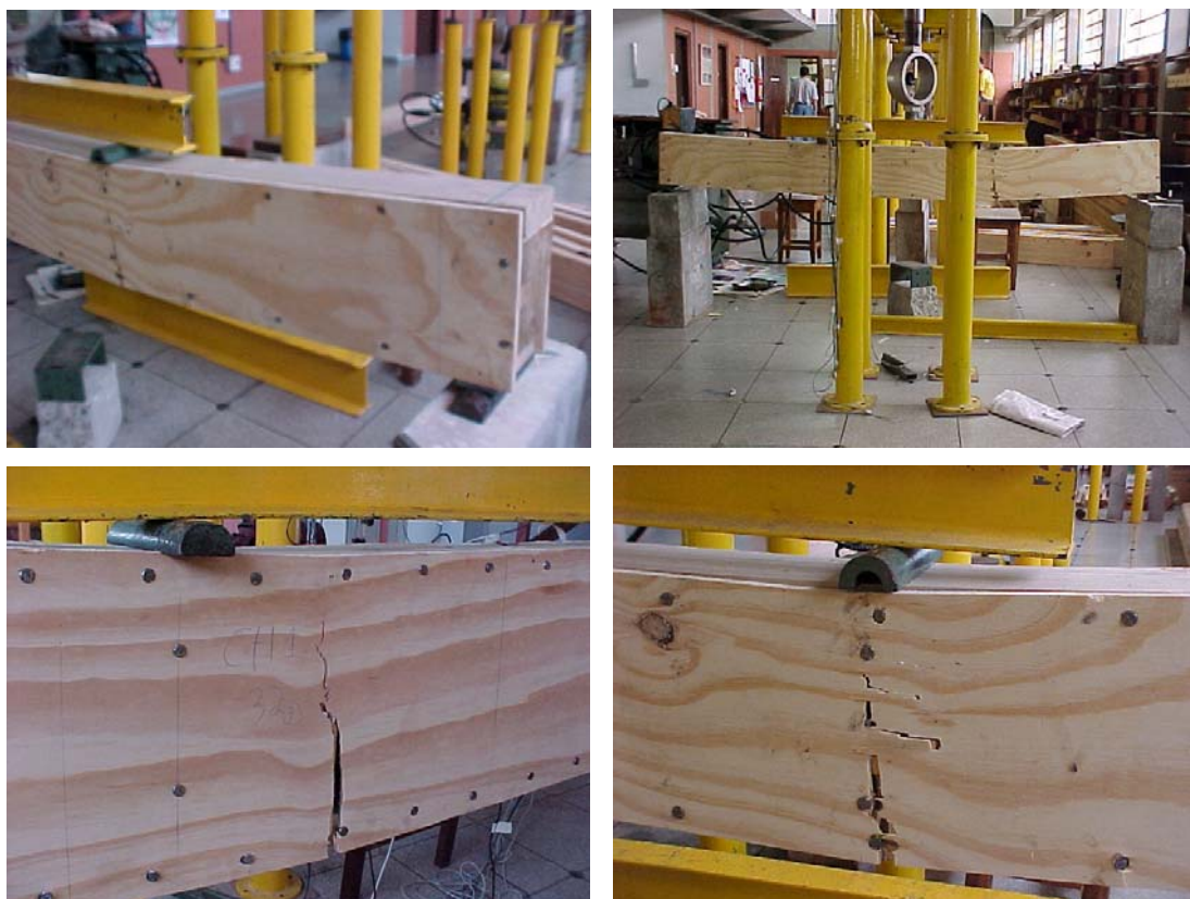
Figura 46 – Modo de ruptura de 8 das 9 vigas rompidas
