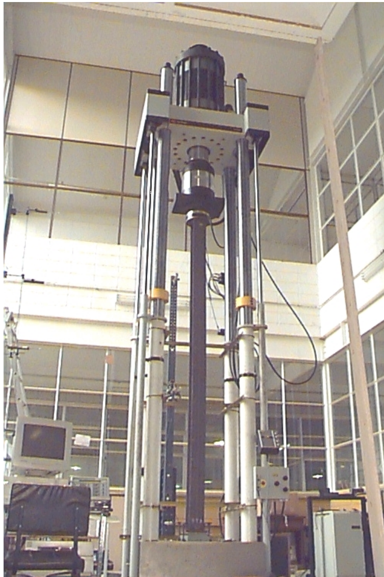
Figura 5.12 - Máquina INSTRON, com o modelo na posição do ensaio.
