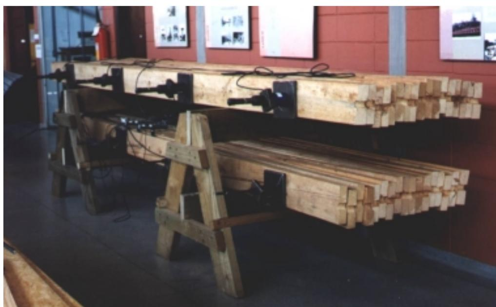
Figura 3.7 – Tabuleiros para o Ensaio de Perda de Protensão.
