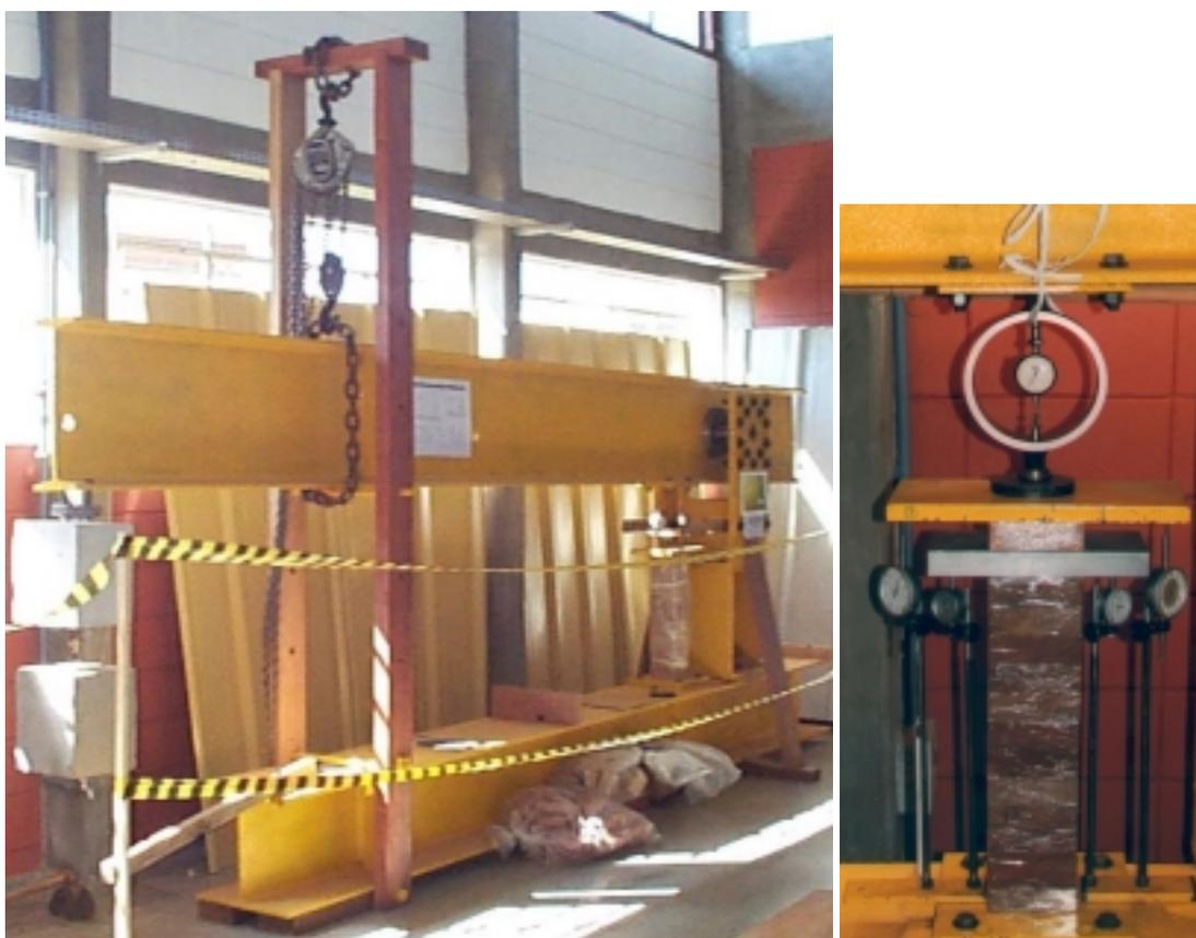
Figura 3.4 – Pórtico de ensaio de Deformação lenta e Corpo-de-prova
