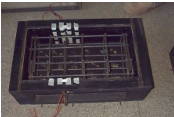
Figura 4.5 - Corpo-de-prova com superfície plana e rugosa ( 5 mm x 20 mm)
