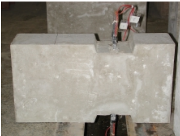
(a) Peça central com chave de cisalhamento
