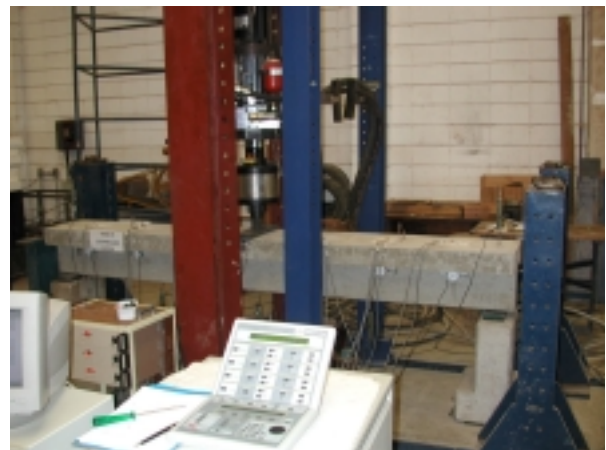
(b) Viga posicionada para ensaio
