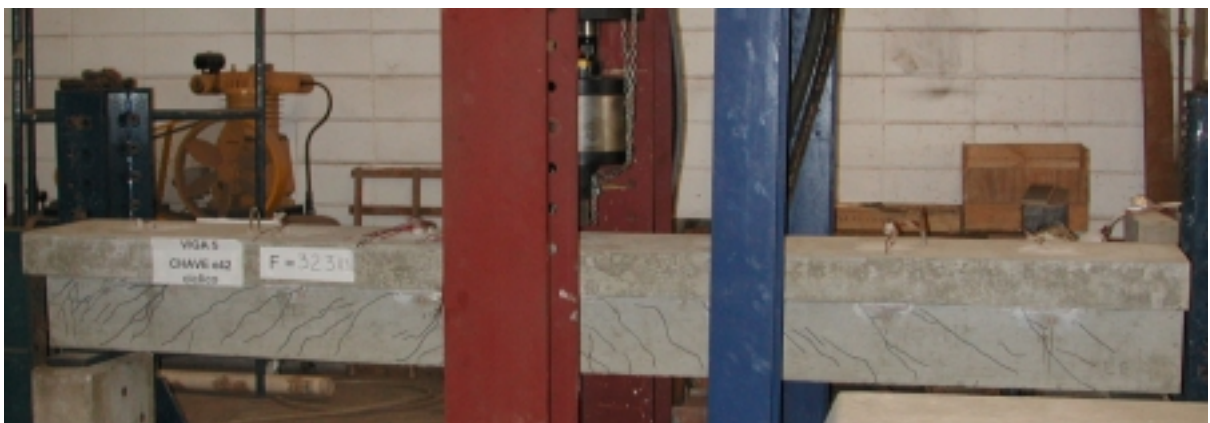
Figura 6.30 – Panorama de fissuração da V5 após a ruptura
