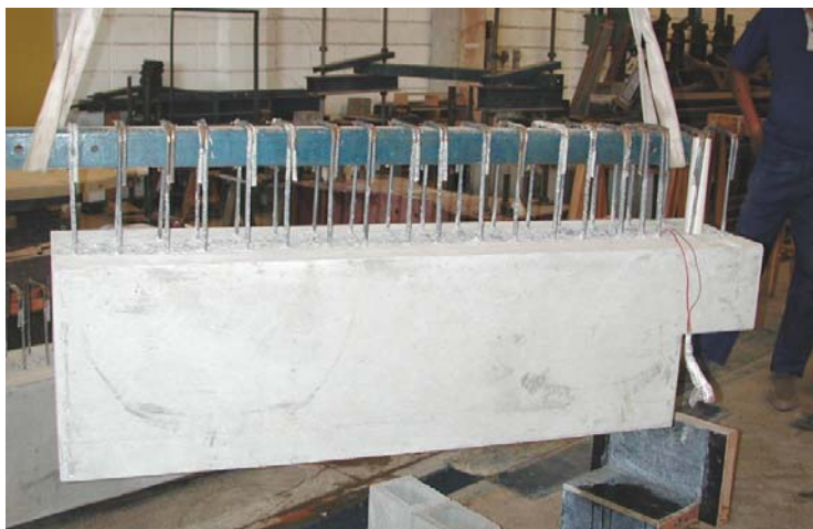
(b) - içamento da viga;
