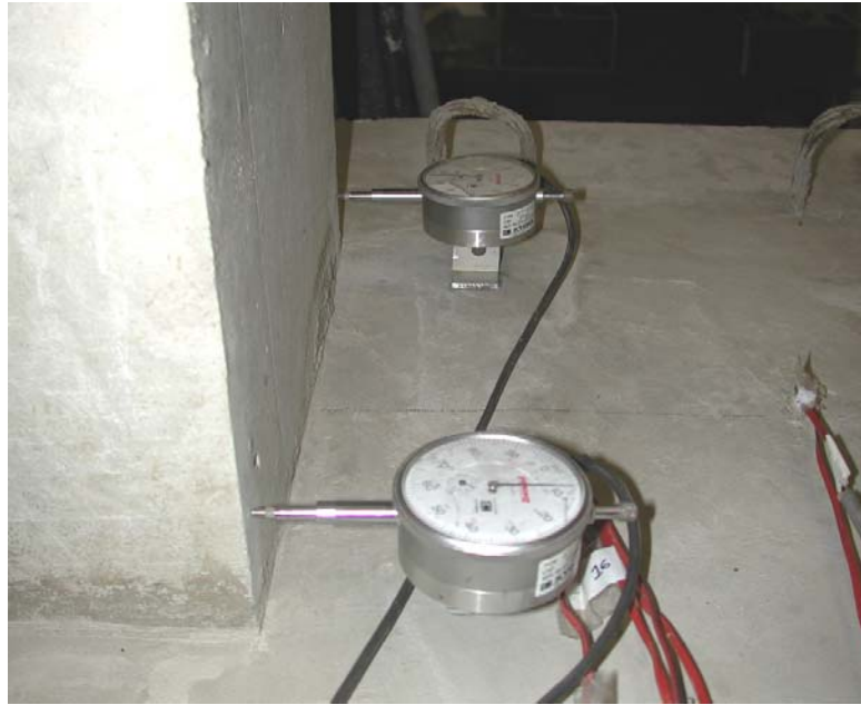
Figura 4.75 - Relógios comparadores para medir os deslocamentos relativos entre a capa e o pilar (modelo 2.1).
