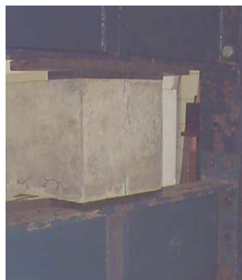
Figura 4.7: (a) - aparelho de apoio do modelo; (b) - dispositivo para aplicação do carregamento.
