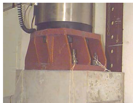
Figura 4.7: (a) - aparelho de apoio do modelo; (b) - dispositivo para aplicação do carregamento.
