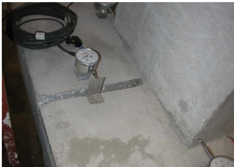
Figura 4.77 - Relógio comparador para medir o deslocamento relativo entre a capa de concreto da esquerda e da direita do modelo 2.2.
