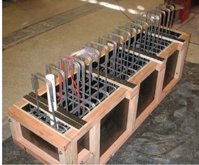
Figura 4.51 - Armadura na fôrma da viga (modelo 2.1).
