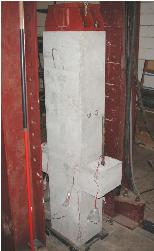
(c) - posicionamento do pilar e almofadas de apoio;
