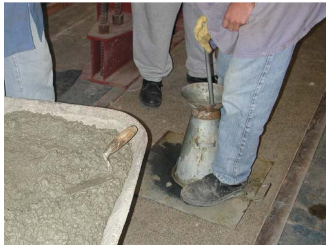
(c) - ensaio de abatimento do tronco de cone;
