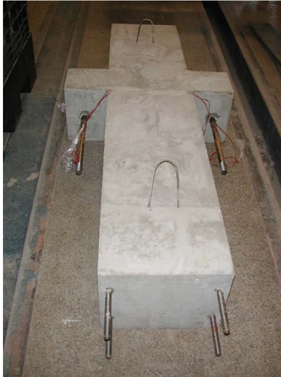
(a) - pilar desenformado;
