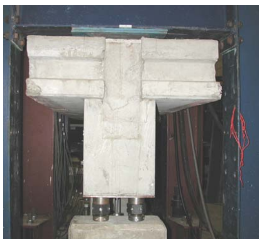
Figura 4.49: (a) - aparelho de apoio do modelo (modelo 2.1);
