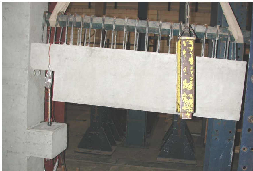
(d) - posicionamento da viga sobre o consolo;
