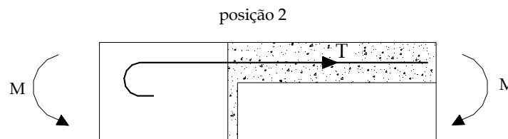
Figura 2.23 – Modelo utilizado no ensaio de flexão - posição 2 [GORGUN (1997)].
