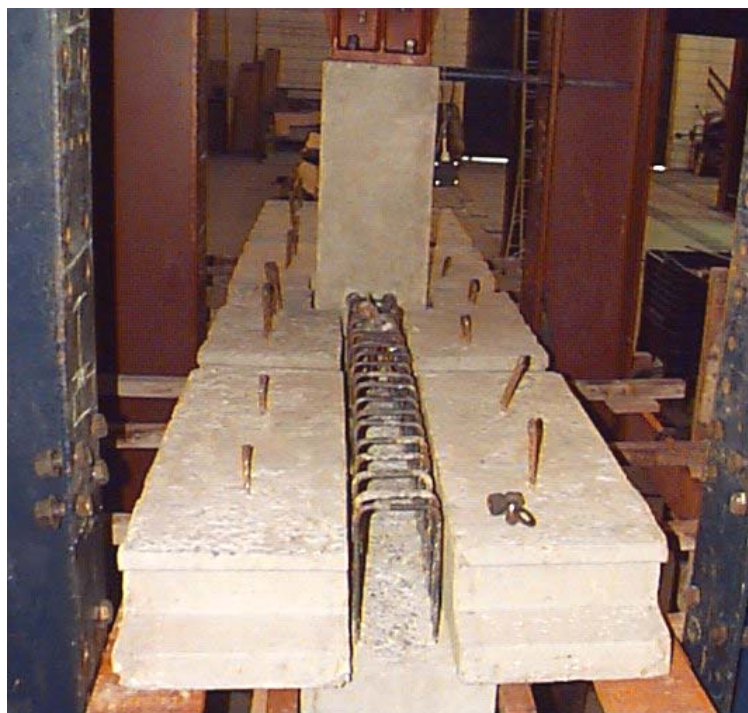
Figura 4.59 - Posicionamento das lajes (modelo 2.1).
