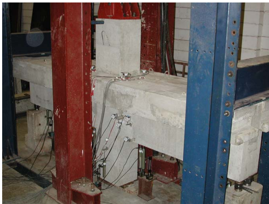
Figura 4.74 - Instrumentação externa do modelo 2.1 - vista.
