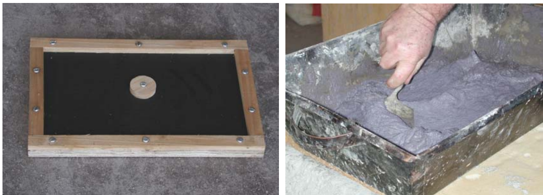
(a) - forma das placas de apoio;
