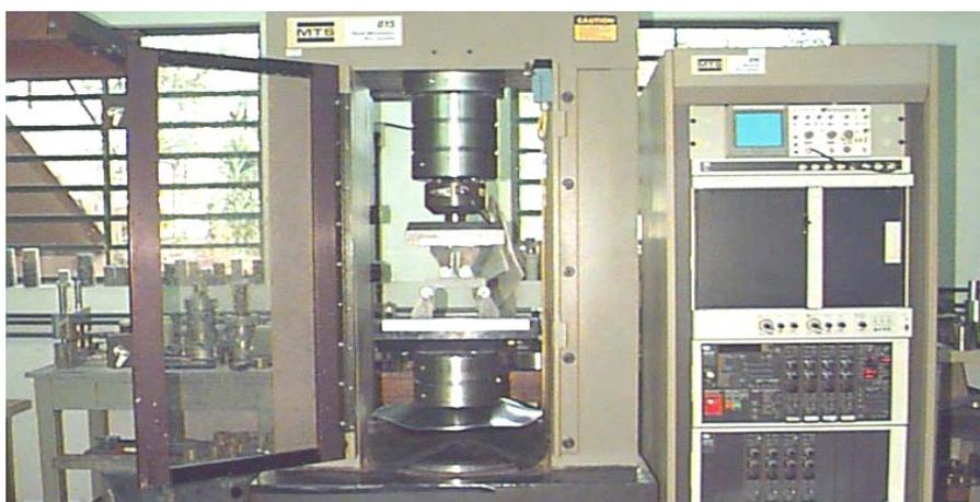
Figura 4.20 – Foto da PRENSA MTS 815 e arranjo do ensaio de flexão em 4 pontos
