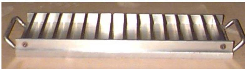
*Figura 4.9 – Foto de uma fôrma para a moldagem de 14 barras B-17*
