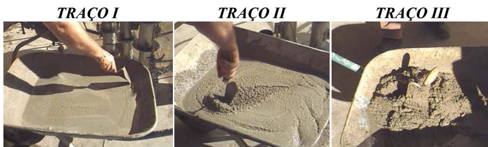
Figura 4.6 – Aspecto do concreto durante a mistura
