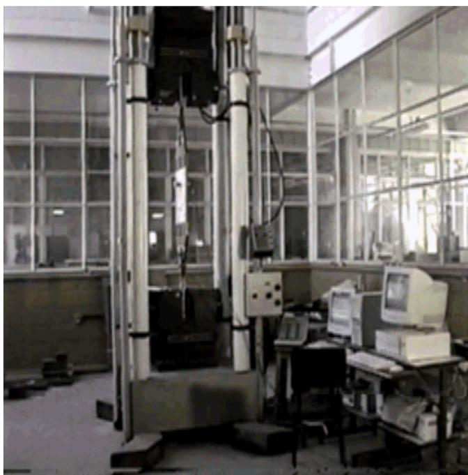
Figura 4.27 – Foto da prensa *INSTRON* utilizada nos ensaios de tração dos painéis armados PA-20 e PA-40, mostrando à direita os computadores com o sistema de aquisição de dados M5000
