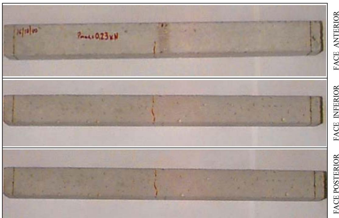
Figura 5.3 – Fotos de um corpo-de-prova B-32 após ensaio de flexão em 3 pontos mostrando uma fissura localizada no ponto médio do vão
