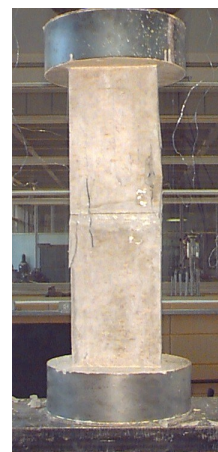
Figura 4. 37: Diagrama tensão x deslocamento do modelo M10DP15SLN-35 e configuração de ruína.
