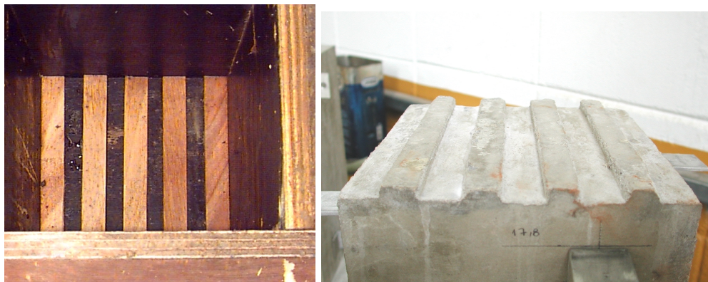
a) ripas coladas no fundo da forma
