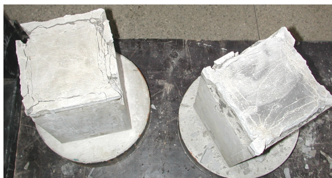
Figura 5. 6: Quebra de aderência na interface segmento superior/junta.
