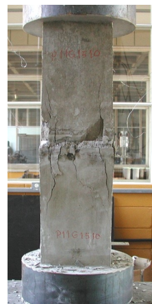
Figura 4. 23: Diagrama tensão x deslocamento do modelo M4G15MLN-35 e configuração de ruína.
