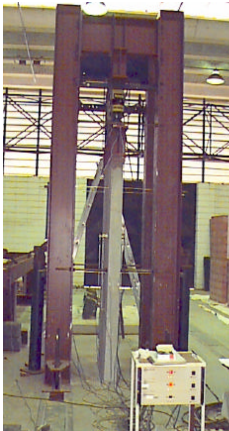
FIGURA D2 – PÓRTICO DE REAÇÃO DO ENSAIO DE COMPRESSÃO CENTRADA
