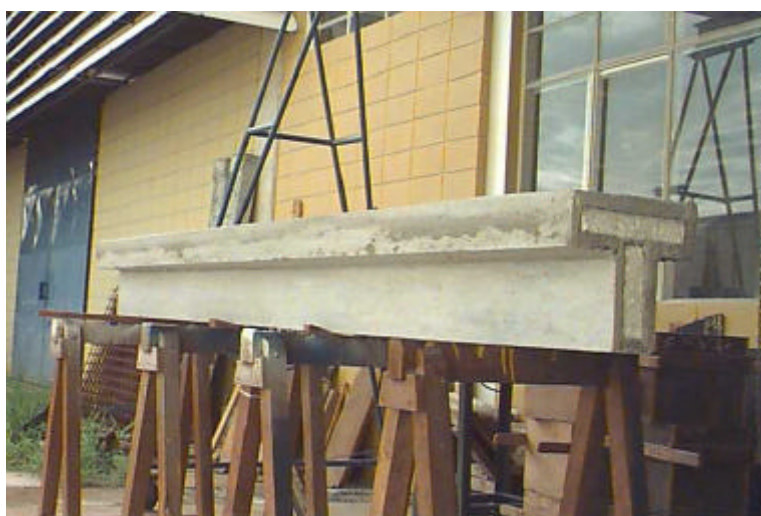
FIGURA C8 – VIGA PRONTA APÓS A SEGUNDA ETAPA DA ARGAMASSAGEM
