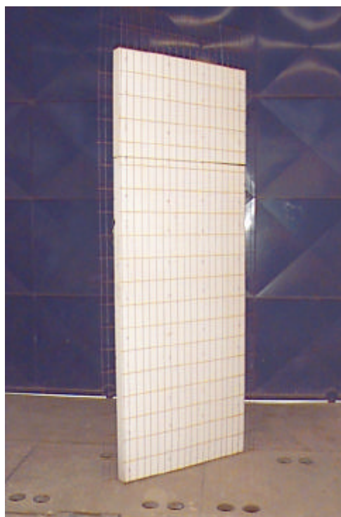
FIGURA 7.2 – PRÉ-PAINEL (NÚCLEO DE EPS + TELA SOLDADA)
