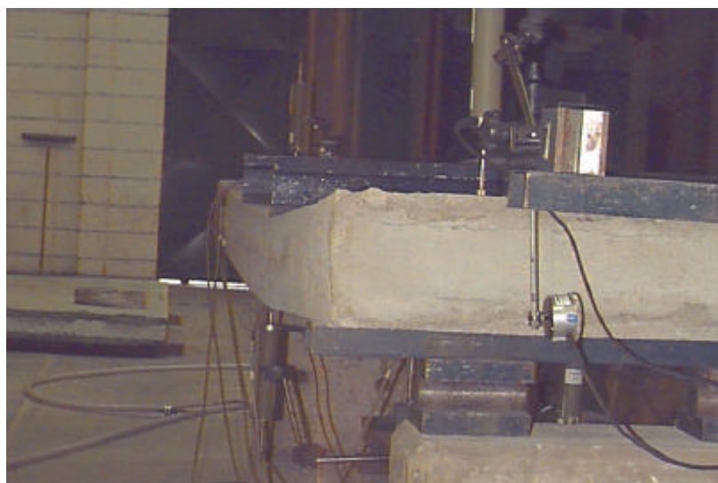
FIGURA 7.18 – ENSAIO DE FLEXÃO EM UMA ETAPA PRÓXIMA DA RUPTURA
