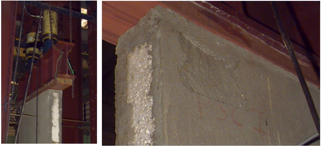
FIGURA D9 – ESMAGAMENTO NA PARTE SUPERIOR DO PSF I
