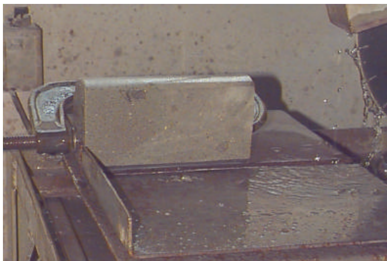
FIGURA 5.4 - DETALHE DO CORPO-DE-PROVA DURANTE O PROCESSO DE SERRAGEM
