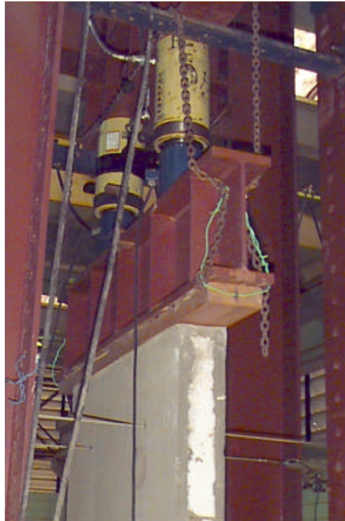
FIGURA D3 – APARATO PARA APLICAÇÃO DO CARREGAMENTO DO ENSAIO DE COMPRESSÃO
