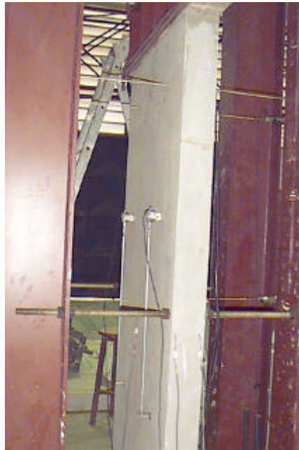
FIGURA D7 – DETALHE DO POSICIONAMENTO DOS TRANSDUTORES ELÉTRICOS HORIZONTAIS
