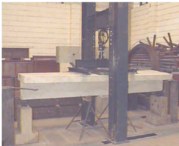
FIGURA 6.19 – MODELO VT 02. DETALHE DO APOIO E DO MECANISMO DE APLICAÇÃO DE CARGA: MACACO HIDRÁULICO E PÓRTICO DE REAÇÃO
