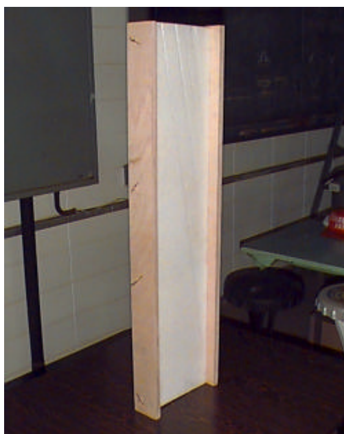
FIGURA 5.7 - FÔRMAS PARA OS PAINÉIS DE EPS
