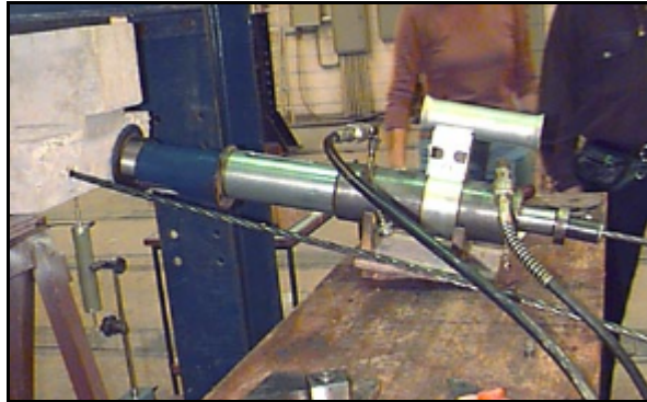
Figura 4.19 - Detalhe do macaco durante a protensão do primeiro cabo da VP-1
