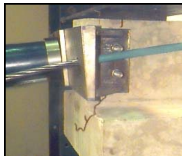
Figura 4.20 - Detalhe da fissuração na ancoragem ativa da viga VP-3
