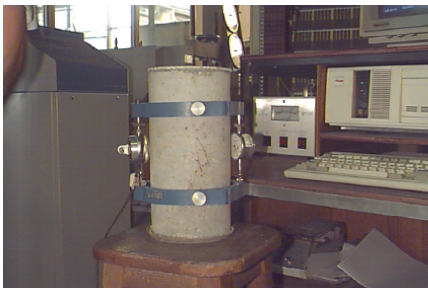
Foto 5 – Corpo de prova 150 mm x 300 mm com anel metálico.
