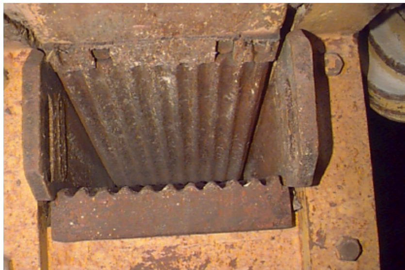
Foto 8 – Britador de mandíbula – detalhe da mandíbula.
