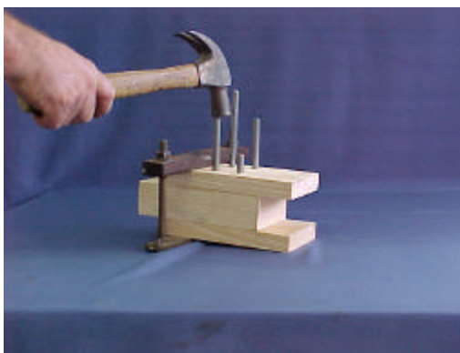
FIGURA 27 – Cravação dos pinos no corpo -de-prova de ligação
