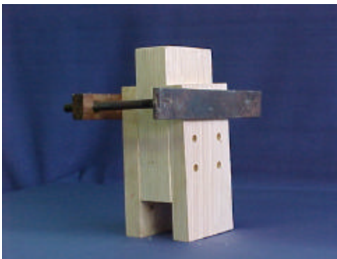
FIGURA 26 – Dispositivo de montagem e pré furação no corpo -de-prova
