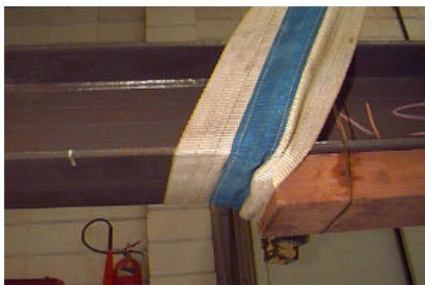
FIGURA 4.23 – Detalhe da fixação da cinta ao perfil metálico
