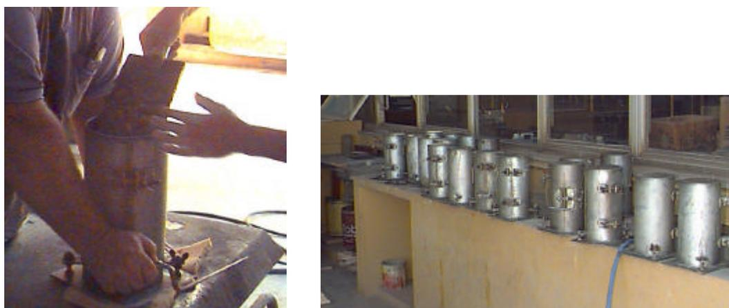
FIGURA 4.32 – Moldagem dos corpos-de-prova
