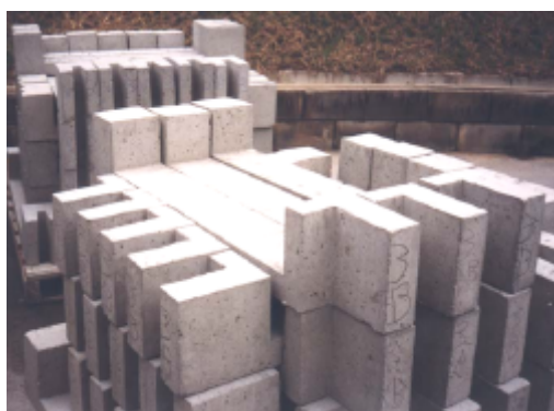
Figura 6.4: Ilustração de vergas com bolhas superficiais
