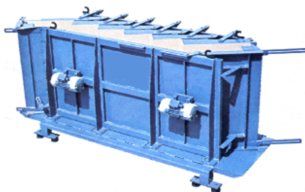
Figura 4.2: Forma metálica de escada composta por peças de grandes dimensões
