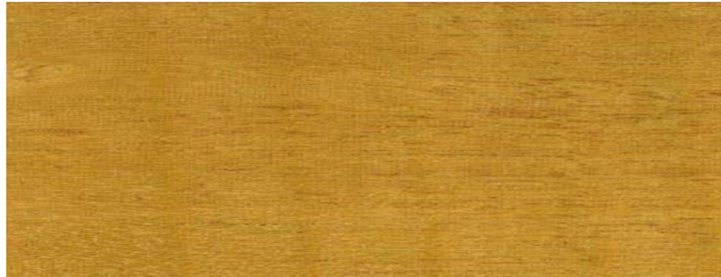
FIGURA 05 – Corte longitudinal - Pau-amarelo ( Euxylophora paraensis )
