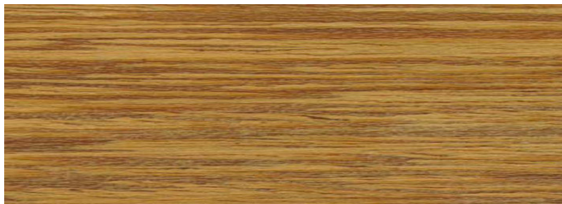
FIGURA 01 – Corte longitudinal - Angelim ( Vatairea sp )
