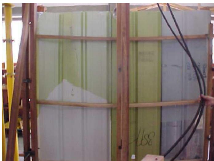
FIGURA 36 - Flexão do painel de cobertura
