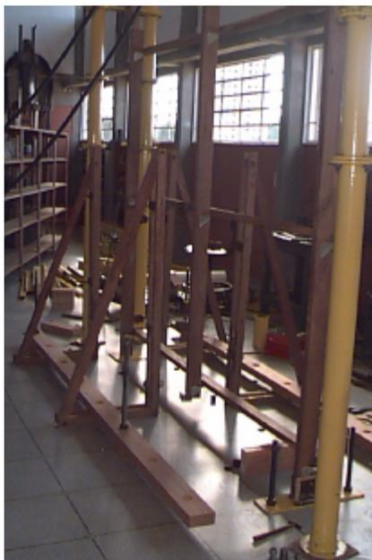
FIGURA 24 – Ensaio para determinação da rigidez da malha de madeira
