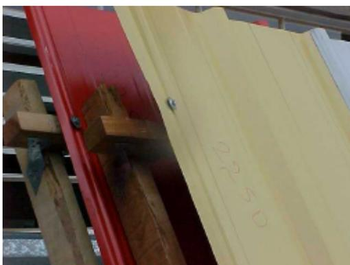
Arrancamento dos parafusos
