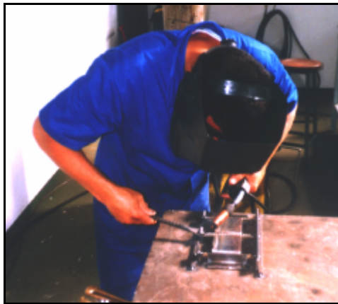
Figura F.7 - Através de um gabarito metálico soldado na mesa, aplicou-se a solda tipo MIG
