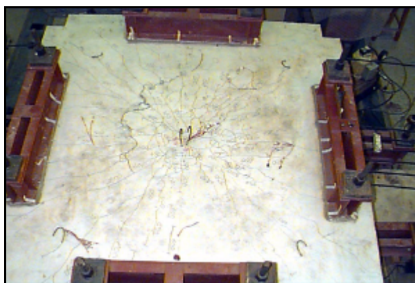
a) Fissuração na face superior do modelo
