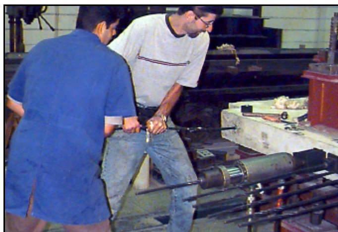
Figura 3.24 - Substituição da cordoalha rompida
