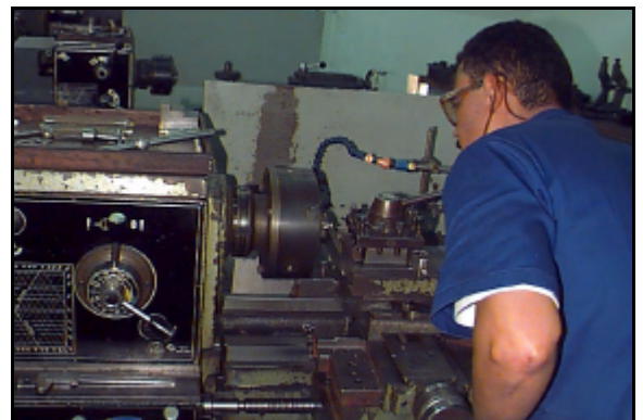
Figura F.4 - Acerto do comprimento do pino e torneamento de suas extremidades para encaixe nas chapas metálicas
