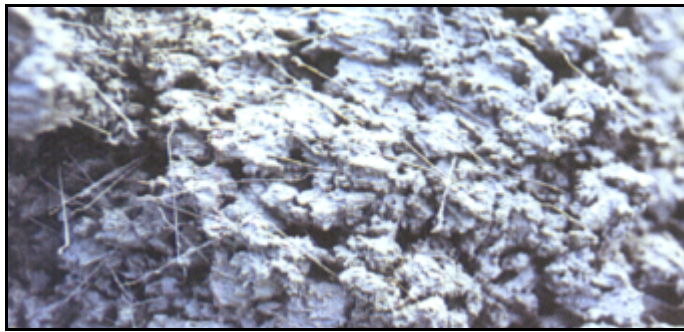
Figura 2.38 - Fibras de aço misturadas junto ao concreto (BEKAERT, s.d.)
