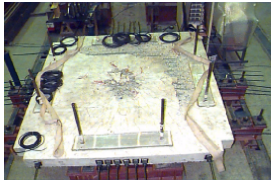
Figura 4.150 - Superfície de ruptura formada após o carregamento pós-ruptura, na face superior do modelo
