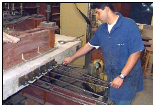
Figura 3.14 - Posicionamento das cunhas
