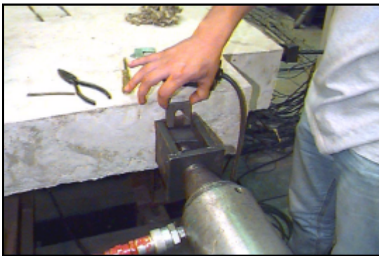
Figura 3.18 - Preenchimento da folga com chapas metálicas
