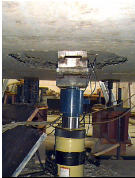
Figura 4.130 - Detalhe da ruptura além da região armada
