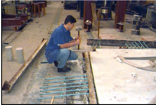
Figura 3.39 - Passagem da faixa entre a fôrma lateral e o modelo
