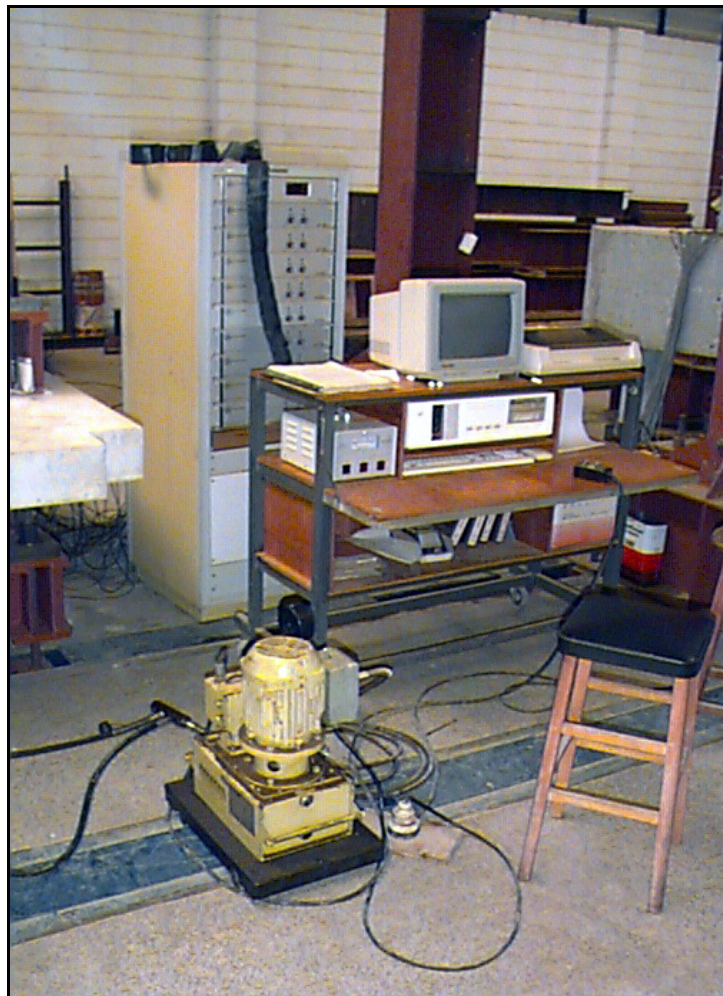
Figura 3.12 - Sistema de aquisição de dados e bomba elétrica
