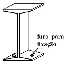
Figura 2.43 - Segmentos de perfis metálicos "I"
