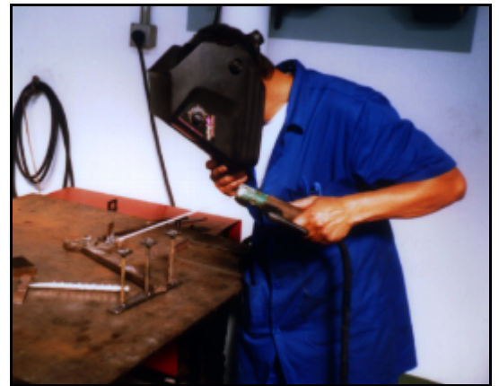
Figura F.8 - Após realizar a solda MIG, executou-se a solda elétrica
