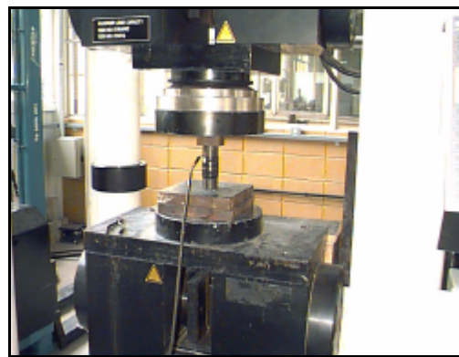
Figura 4.3 - Célula de carga sendo calibrada na máquina Instron
