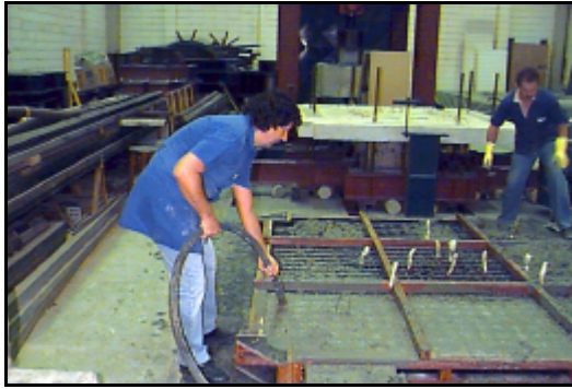
a) Laje de concreto armado
