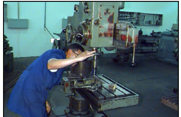
Figura F.2 - Furação das chapas metálicas para futuro encaixe dos pinos
