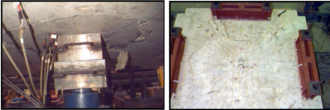
a) Vista do carregamento na face inferior da laje b) Vista da fissuração na face superior da laje
