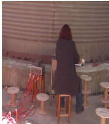
(a) conexão das células de pressão ao sistema de aquisição de dados
