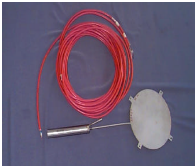
FIGURA 44 – Célula de pressão utilizada para medição direta das pressões
