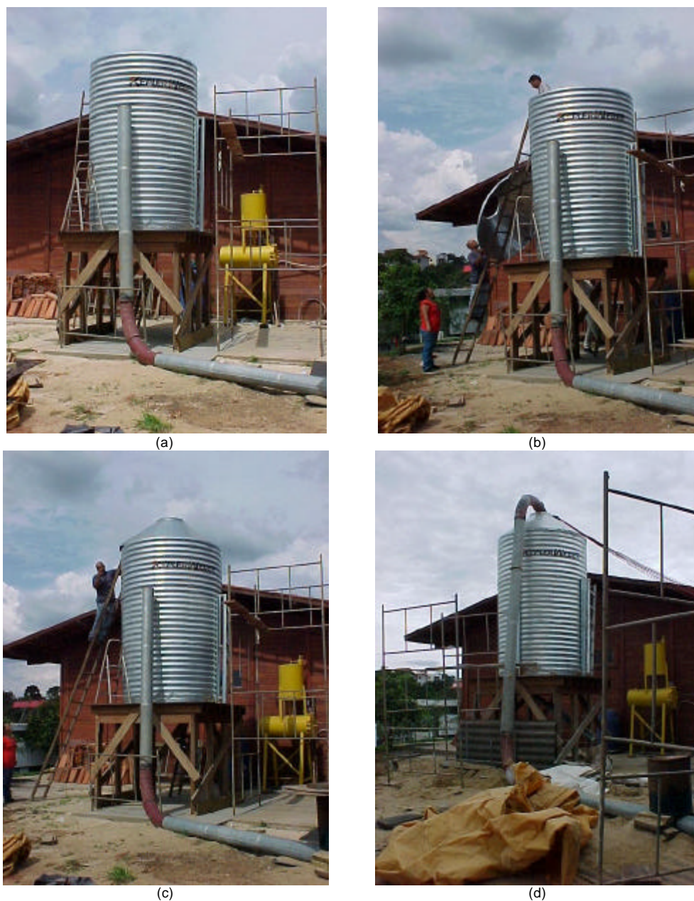
FIGURA 59 – Montagem do silo piloto para a realização dos ensaios com relação h/d=1,25 e h/d=1,49
