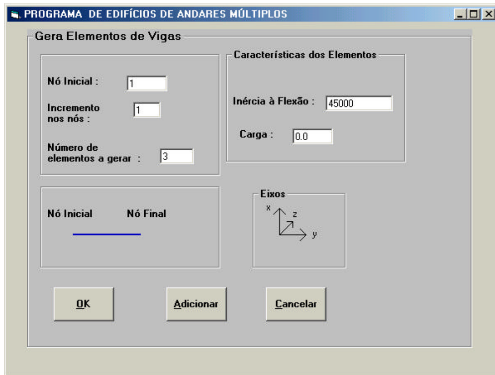
Figura 66 : Janela para geração de elementos de barra
