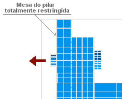
Figura 4.27 – Direção do deslocamento prescrito para a protensão dos parafusos
