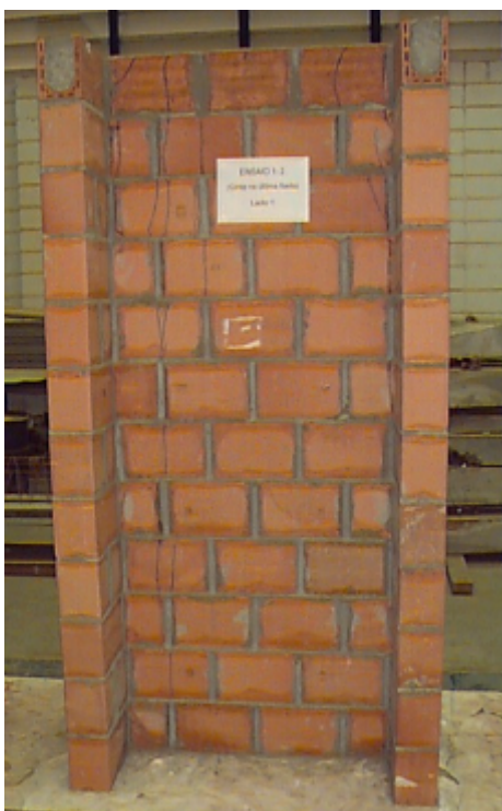
Figura 48 - Forma de ruptura da série 1
