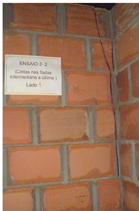
Figura 49 - Forma de ruptura da série 2
