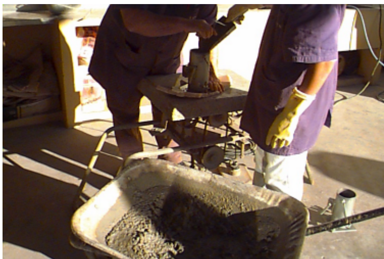
FIGURA 4.3 – Moldagem dos corpos-de-prova cilíndricos 10 cm x 20 cm
