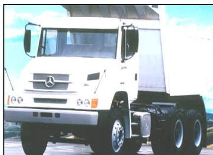
Figura 3.4 – Veículo rodoviário com eixo tandem duplo <sup>2</sup>
