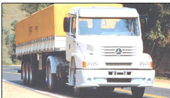
Figura 3.3 – Veículo rodoviário com eixos simples e tandem triplo <sup>1</sup>
