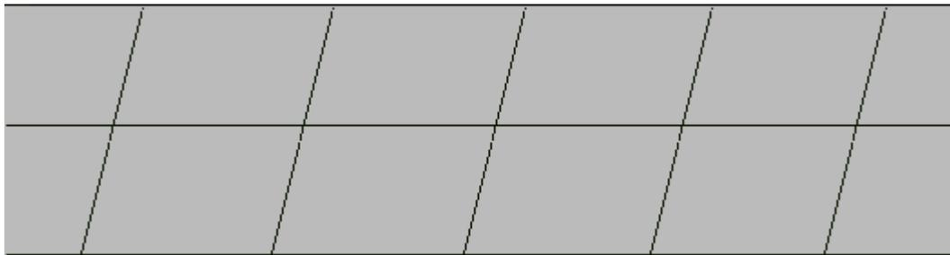
Figura 8.3 – Pavimento de concreto com juntas transversais inclinadas
