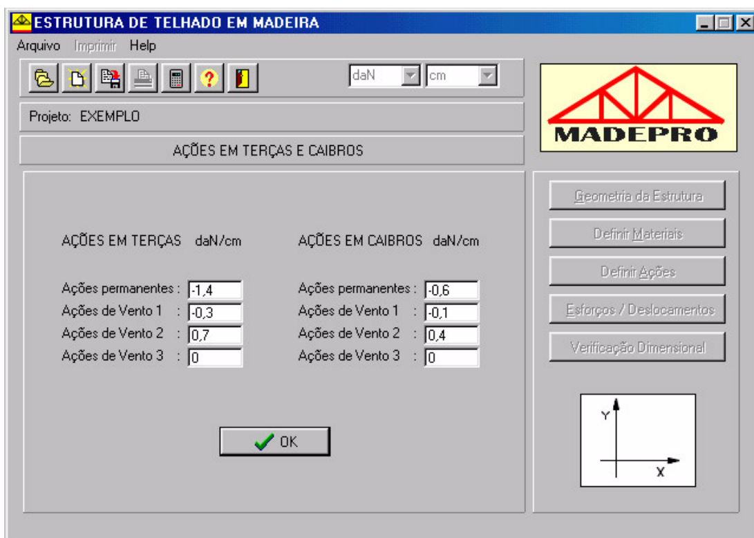
FIGURA 35 - Ações em terças e caibros da estrutura
