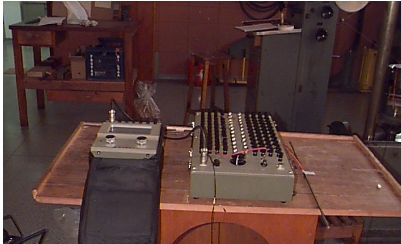
FIGURA 4.4 – Equipamentos de medição: ponte para medição de deformação e caixa seletora
