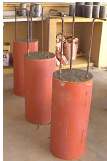
Figura 4.15. Fôrma das estacas com D = 30 cm
