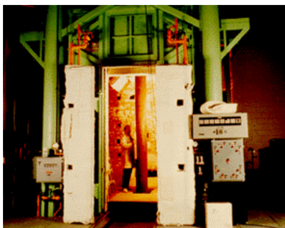
FIGURA 5.14 - FORNO QUE SIMULA A ELEVAÇÃO DE TEMPERATURA PRODUZIDA PELA AÇÃO DO FOGO E ONDE FORAM ENSAIADOS OS PILARES MISTOS PREENCHIDOS 4
