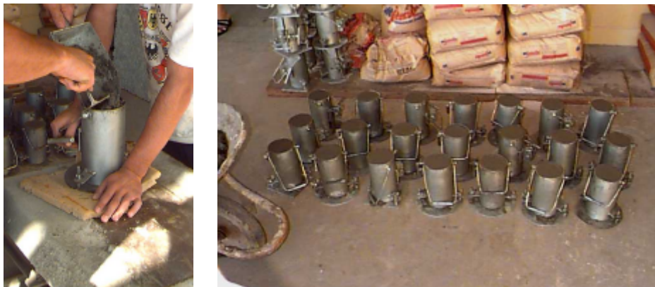
FIGURA 4.4 - Moldagem dos corpos-de-prova
