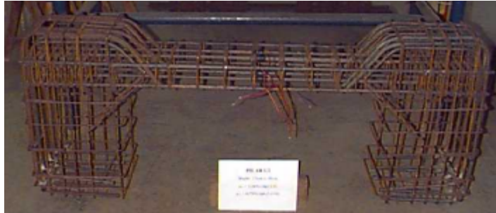
FIGURA 4.9 - Armadura do pilar P1/2
