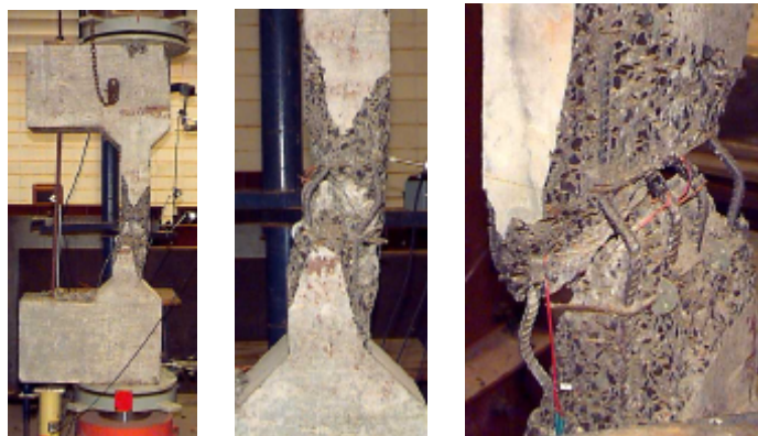
FIGURA 4.25 - Forma de ruptura do pilar P1/3
