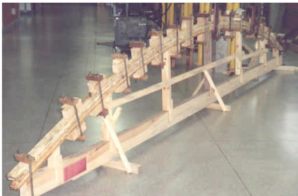
a) Arco com as lâminas coladas e prensadas ao longo do gabarito.
