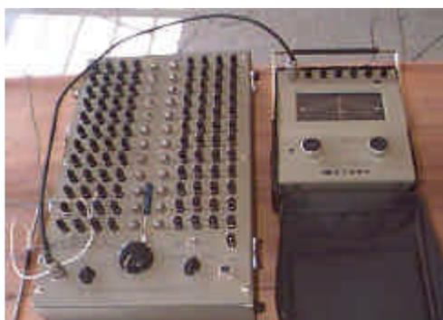
**FIGURA 137** – Aparelho de leitura utilizado no ensaio, composto pela caixa de balanceamento e pelo indicador de deformações.
