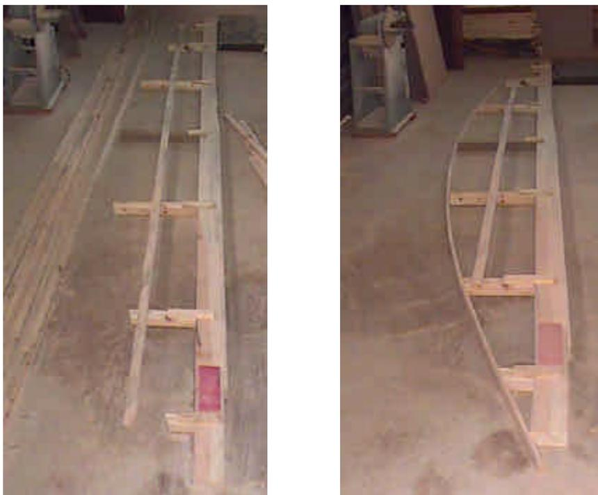
**FIGURA 118** – Gabarito para a montagem dos arcos.
