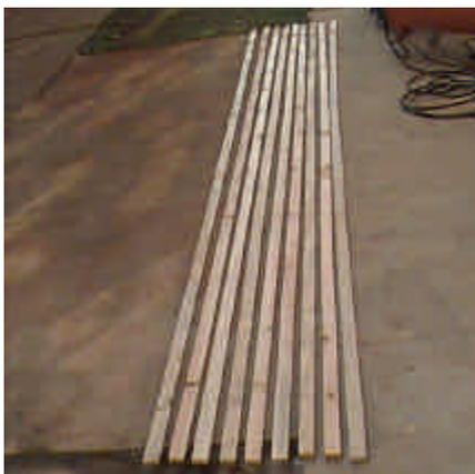
**FIGURA 113** – Lâminas utilizadas para a construção dos arcos.
