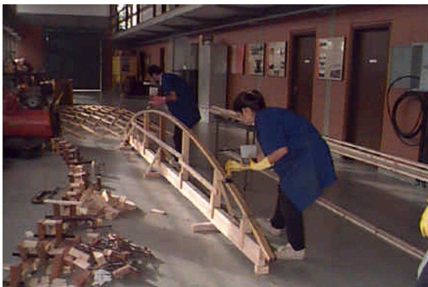
**FIGURA 119** – Aplicação do adesivo por pincelamento, na face da lâmina já fixada no gabarito.
