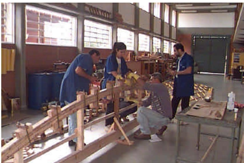
**FIGURA 120** – Fixação das lâminas com prensas móveis.
