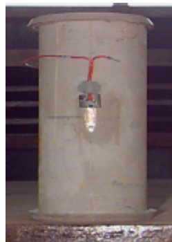
Figura 2.13. Detalhe da instrumentação dos corpos-de-prova usados para a determinação do módulo de elasticidade do concreto
