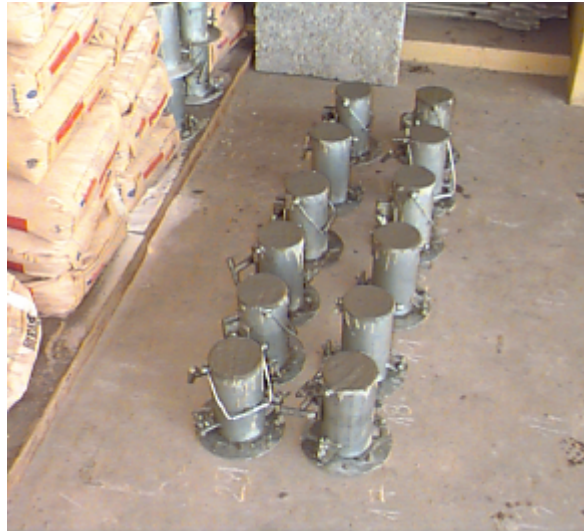
Figura 4.6. Detalhe dos corpos-de-prova moldados para cada série de pilares
