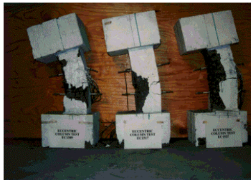
Figura 2.1. Ensaio sobre o comportamento de pilares de CAR submetidos à flexo-compressão, XIAO e ANDERSON 1
