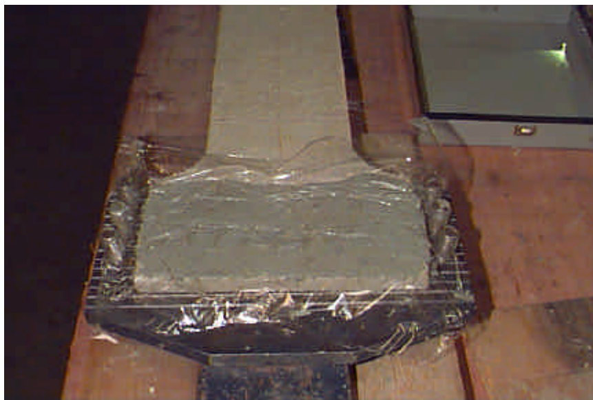
Fig. 5.8: Montagem do sistema garra/placa: (a) divisão da placa em regiões e colocação de entalhe, (b) colocação de massa colante de epóxi, e (c) montagem da garra
