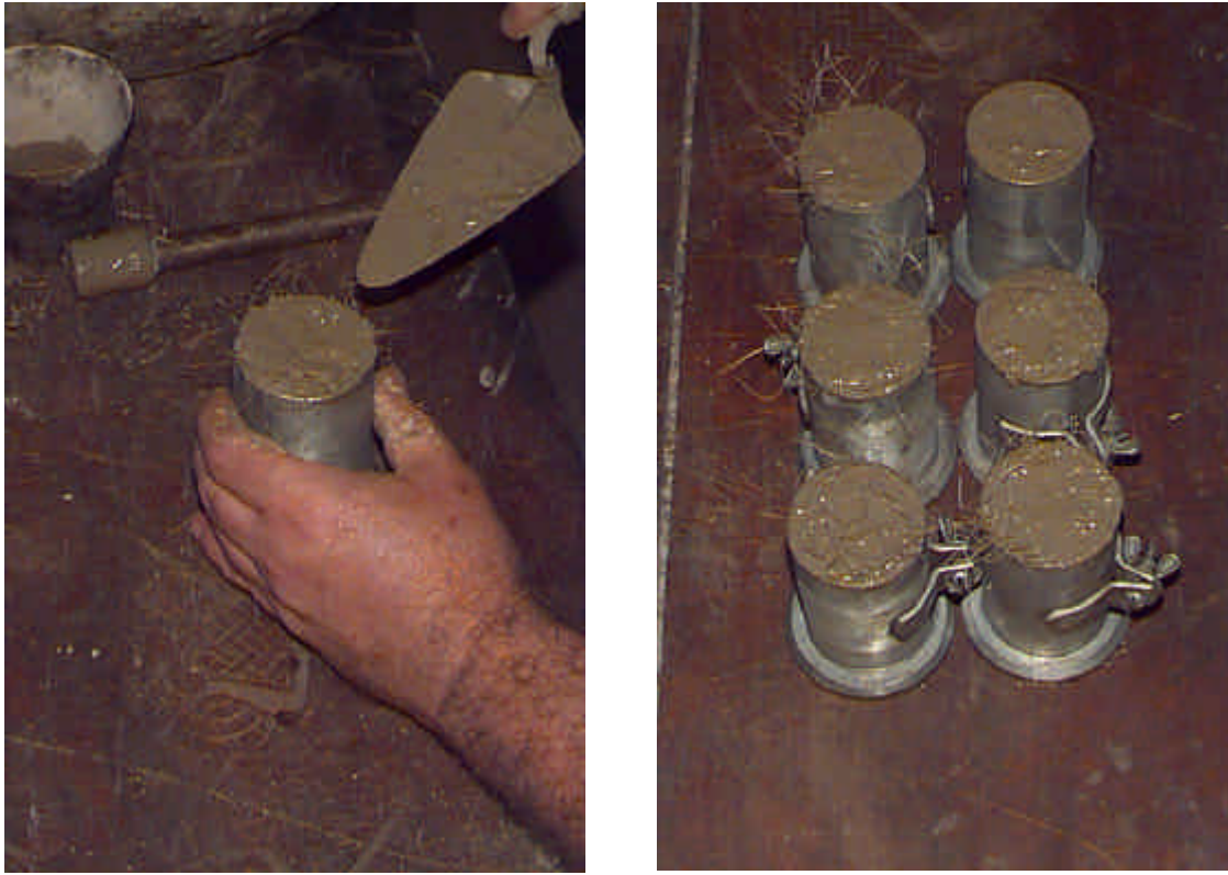
(a) (b) Fig. 5.7: Moldagem dos corpos de prova: (a) acabamento do corpo de prova, e (b) visão geral dos corpos de prova moldados
