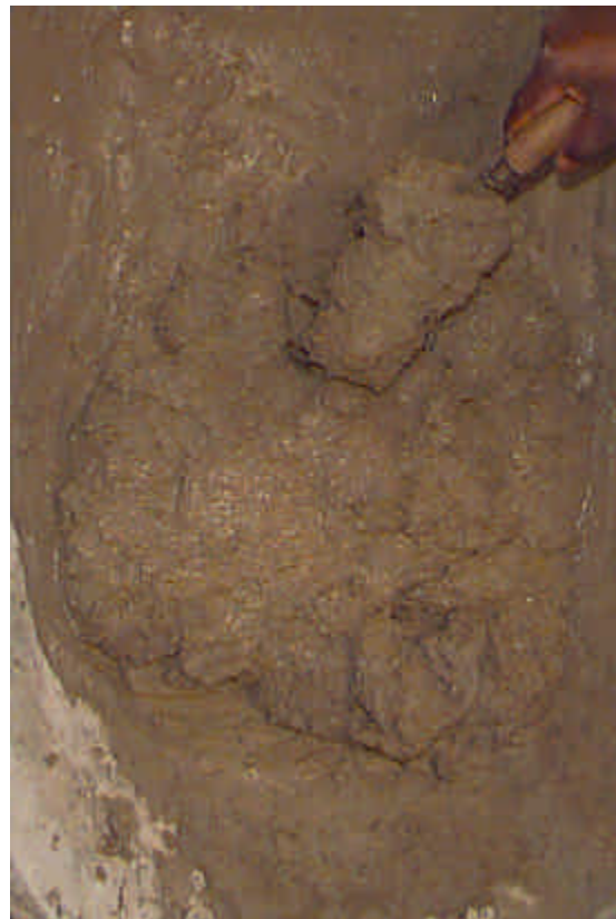
Fig. 5.4: Processo de mistura: (a) mistura de fibras na argamassa, (b) verificação da consistência da mistura.
