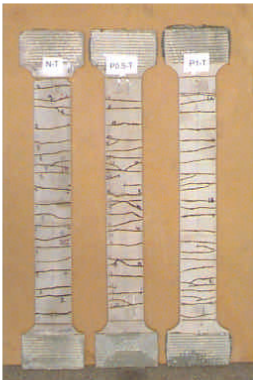
Fig. 5.13: Modo de fissuração da série N-T; P0,5-T; e P1-T
