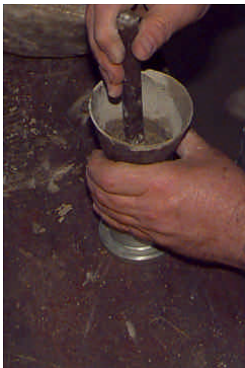
(a) (b) Fig. 5.6: Moldagem dos corpos de prova: (a) preenchimento da forma, e (b) compactação
