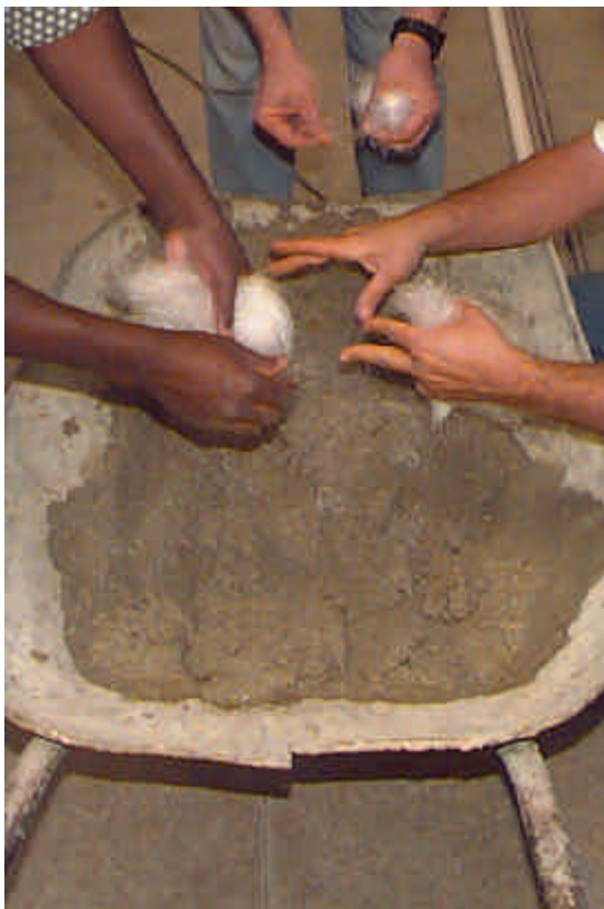
Fig. 5.4: Processo de mistura: (a) mistura de fibras na argamassa, (b) verificação da consistência da mistura.
