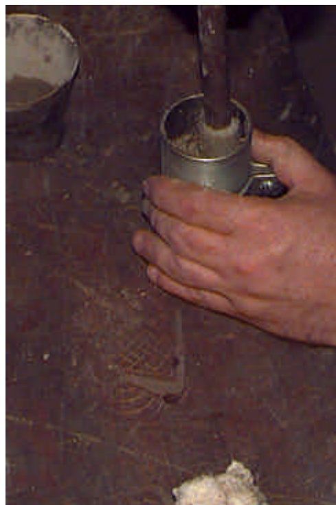
(a) (b) Fig. 5.6: Moldagem dos corpos de prova: (a) preenchimento da forma, e (b) compactação
