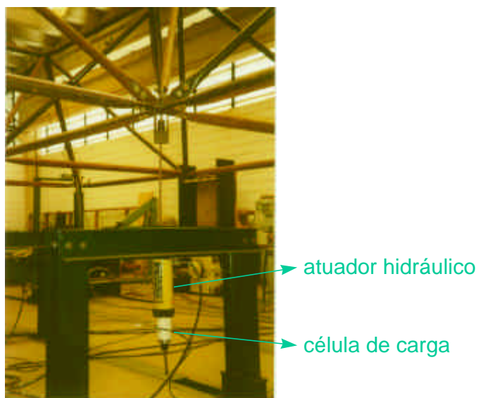
FIGURA 3.13 - Posicionamento da célula de carga
