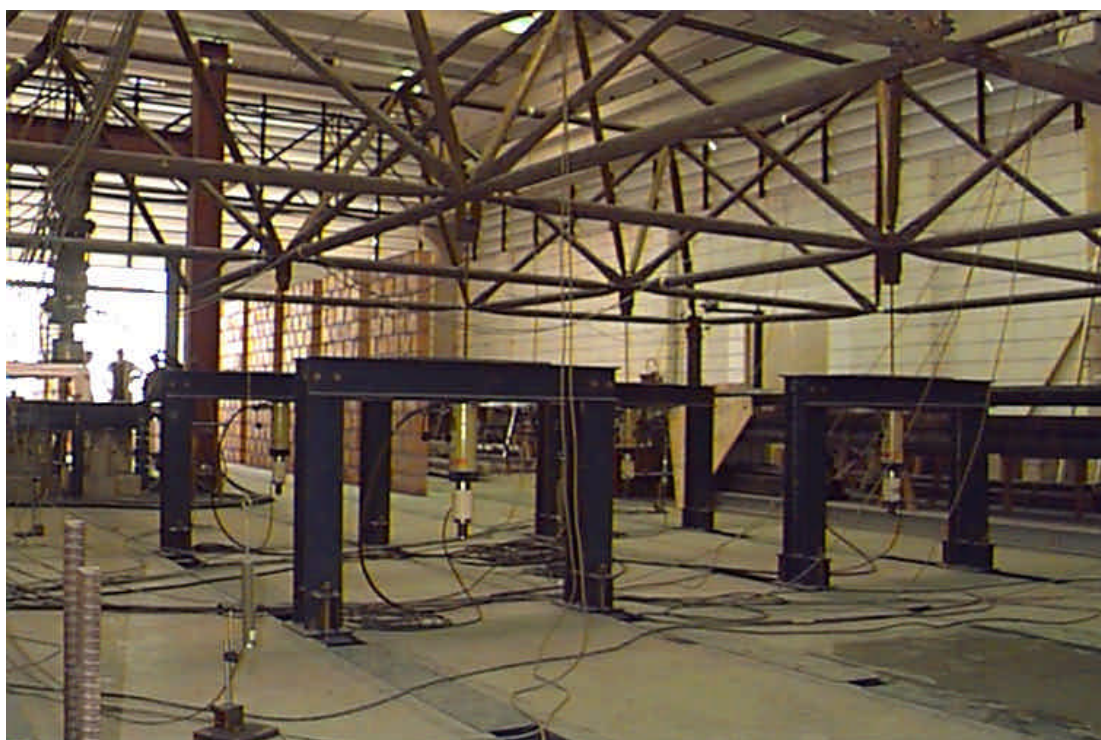
FIGURA 3.6 - Vista geral das estruturas de reação para aplicação de força
