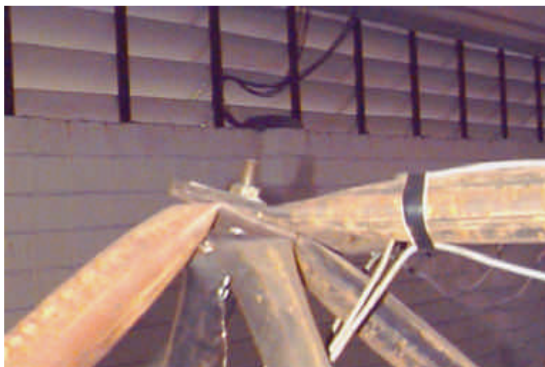
FIGURA 5.22 - Rotação do nó junto ao vértice D (PROT 1).
