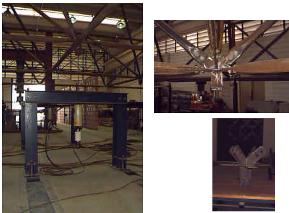
FIGURA 3.10 - Detalhe do sistema de aplicação de forças e do nó de aço fabricado para ancoragem da cordoalha
