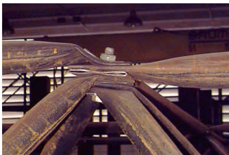
FIGURA 5.23 - Flexão de extremidade da barra do banzo superior (PROT 1).
