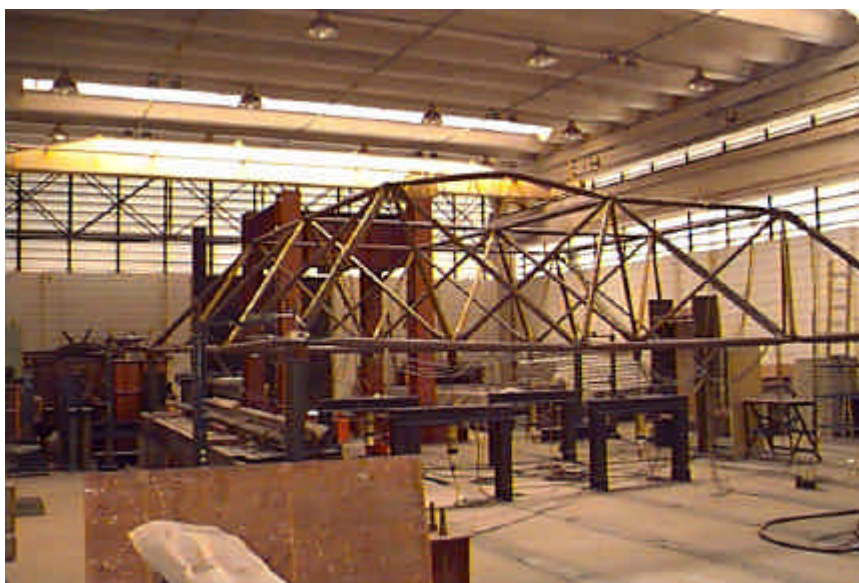
FIGURA 5.25 - Flambagem de uma barra do banzo superior do PROT4
