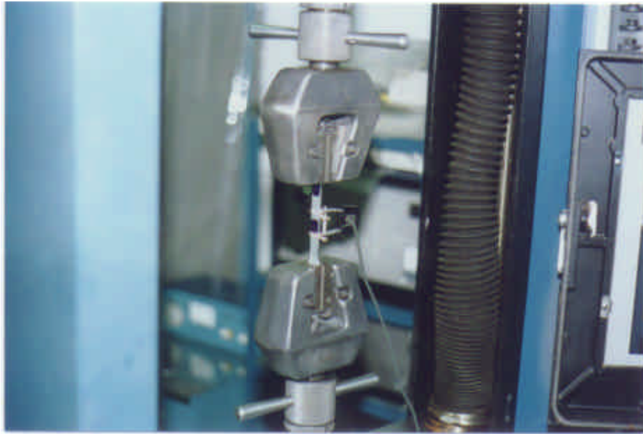
FIGURA 5.16- Vista geral do ensaio de tração do aço.
