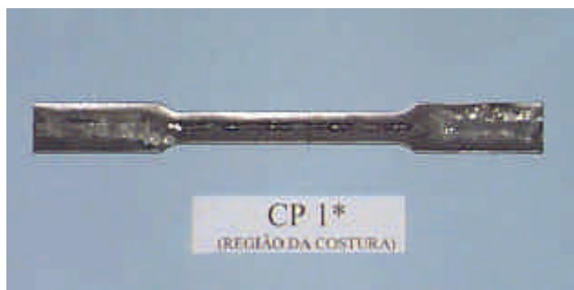
FIGURA 5.15 - Corpo-de-prova retirado da região da costura.
