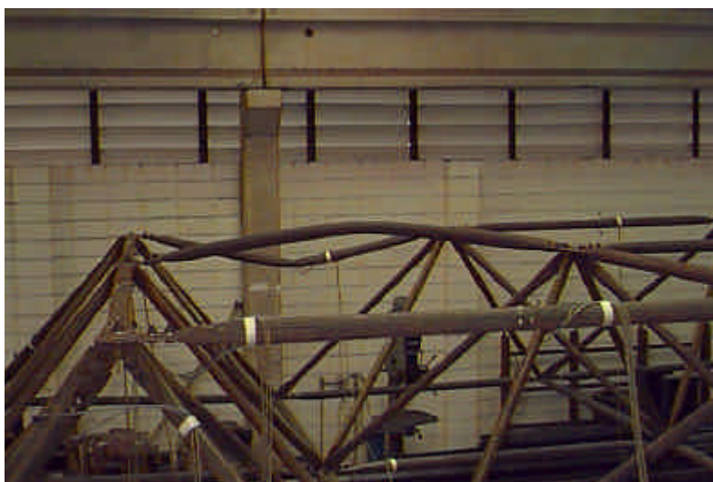
FIGURA 5.24 - Flambagem de duas barras do banzo superior do PROT3
