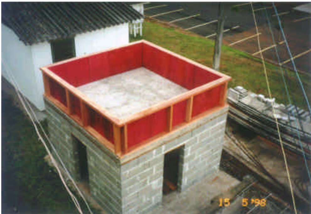
Fig.5.3 Vista geral do protótipo e do suporte de madeira utilizado para o carregamento com água
