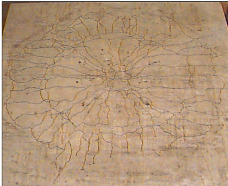
Figura 5.21 – Face tracionada dos modelos de laje-cogumelo com CBR e 0,75% de fibras
