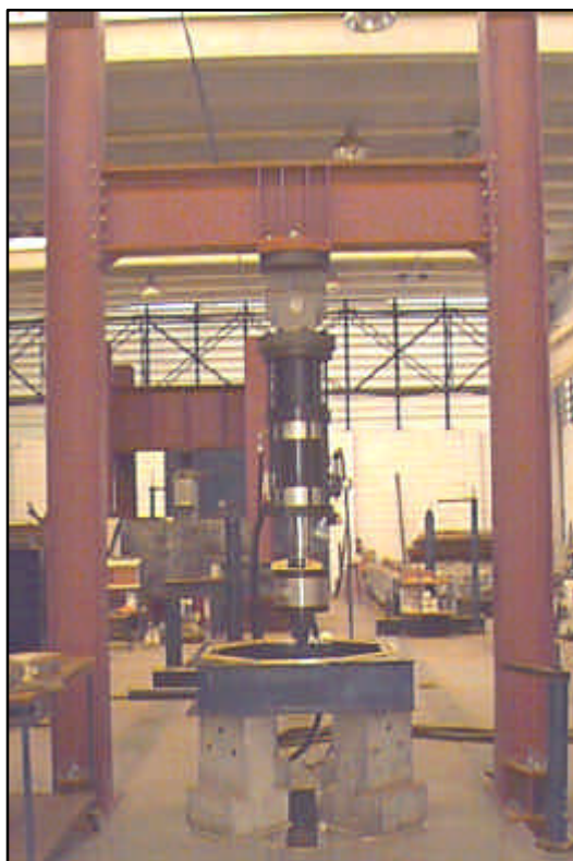
Figura 5.18 – Esquema de ensaio dos modelos de ligação laje-pilar
