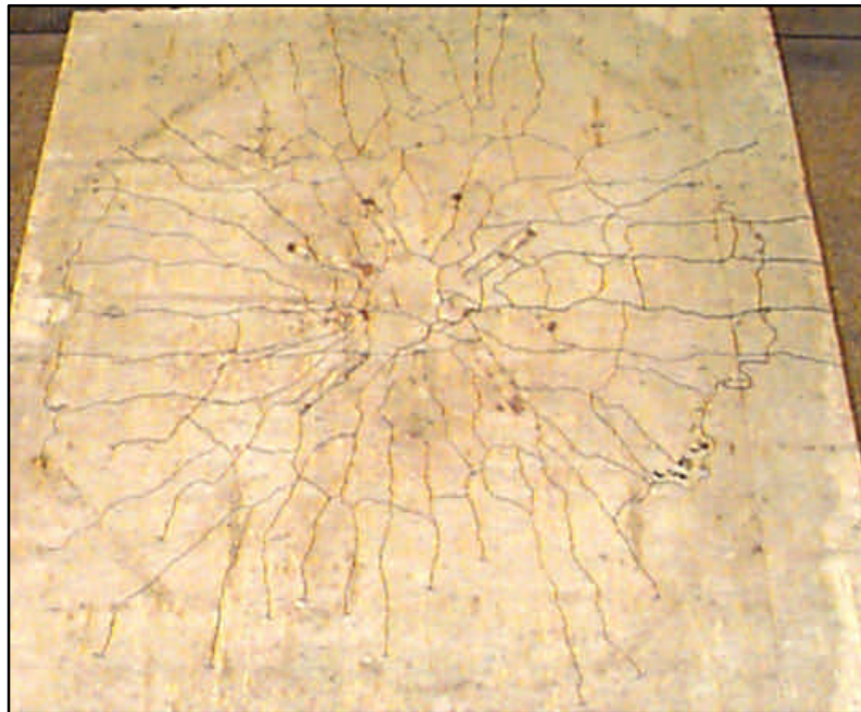
Figura 5.23 – Face tracionada dos modelos de laje-cogumelo com CAR e sem fibras
