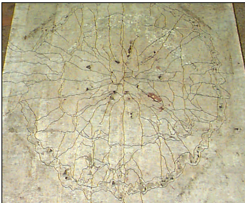
Figura 5.24 – Face tracionada dos modelos de laje-cogumelo com CAR e 0,75% de fibras
