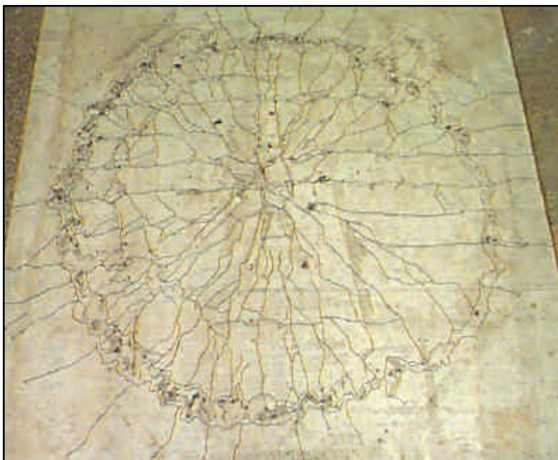
Figura 5.25 – Face tracionada dos modelos de laje-cogumelo com CAR e 1,50% de fibras
