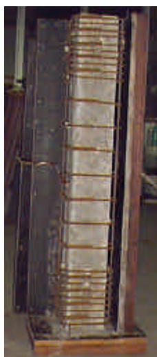
Foto 5.12 - Armadura de reforço do modelo S3C3S
