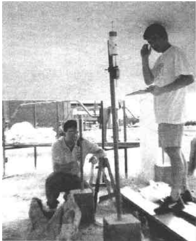
FIGURA 65. Vista geral do posicionamento dos defletômetros durante a prova de carga do Protótipo II.
