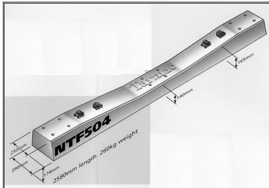
Fig. 2.24 - Dormente inglês modelo NTF504 (FONTE: TARMAC - 1996).
