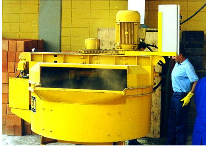
*Fig. 7.15 - Betoneira utilizada na mistura.*
