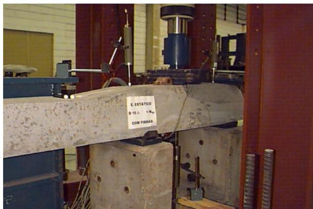
Fig. 8.3 - Ensaio para verificação do dormente ao momento positivo na seção sob o trilho.
