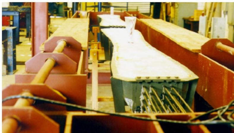
*Fig. 7.7 - Estrutura de protensão com dois dormentes concretados.*
