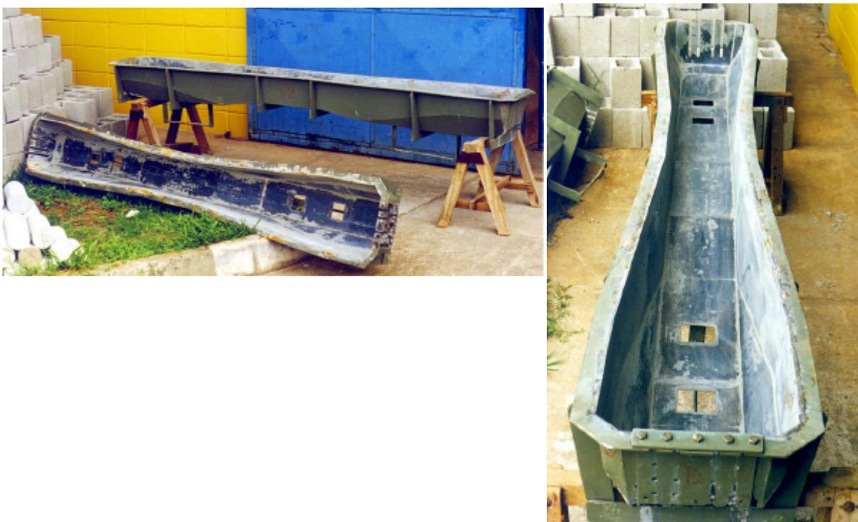
Fig. 7.1 - Moldes metálicos para a fabricação dos dormentes.
