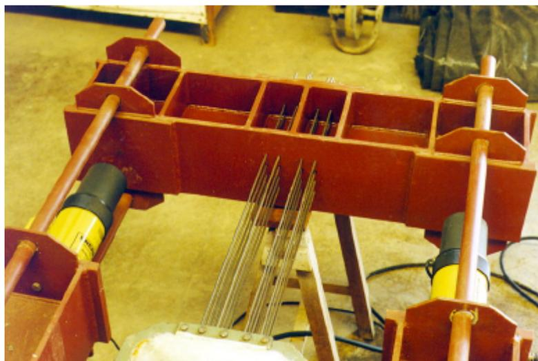
*Fig. 7.11 - Cilindros para estiramento dos fios de protensão.*
