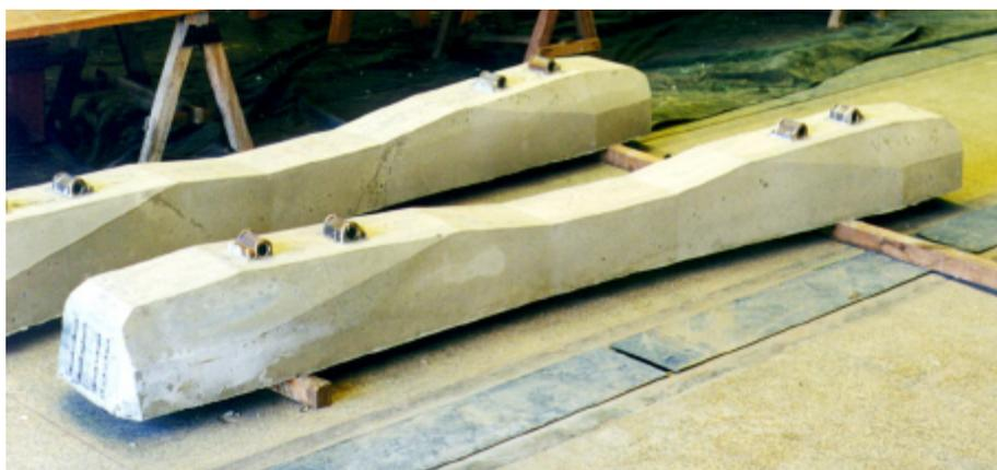
*Fig. 7.20b - Aspecto dos dormentes fabricados.*
