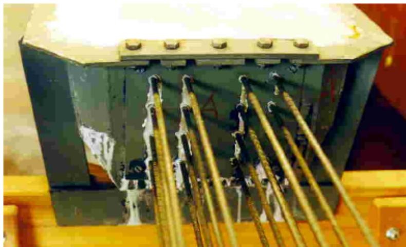
*Fig. 7.19 – Vazamento de nata nas extremidades do molde.*
