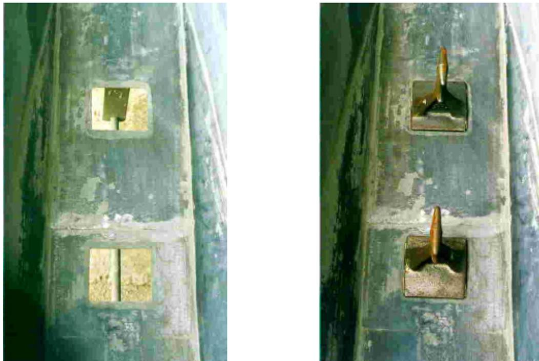
*Fig. 7.5 – Posicionamento das ombreiras no molde.*
