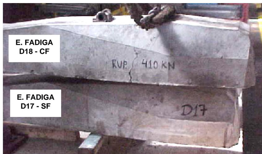
*Fig. 8.56 - Configuração final dos dormentes D17 e D18 após o término do ensaio de fadiga.*
