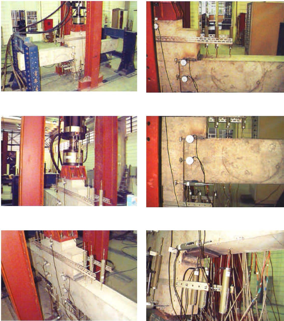
**Figura 5.22** – *Detalhes dos posicionamentos dos transdutores de deslocamento*
