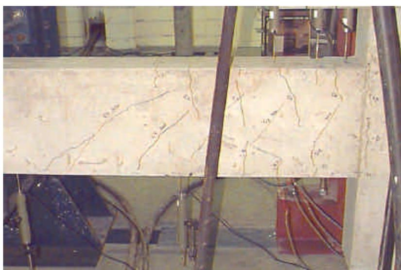
**Figura 5.29** – Fissuras no lado esquerdo do Protótipo Monolítico
