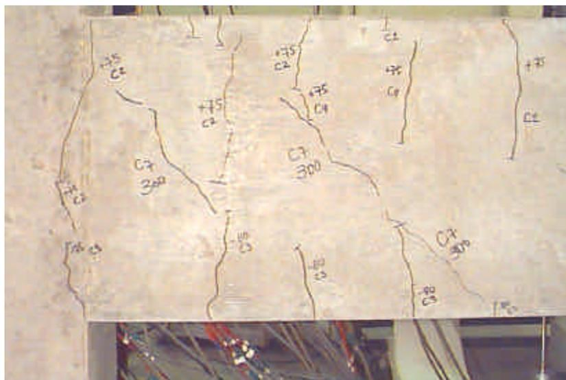
**Figura 5.28** – Fissuras no lado direito do Protótipo Monolítico
