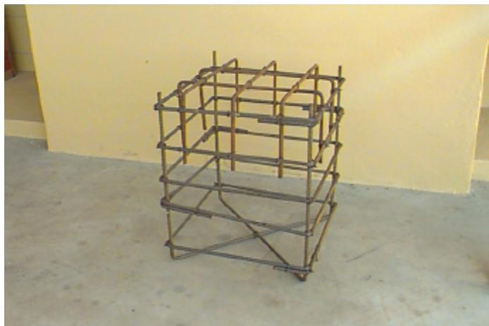
**Figura 4.12 – Foto da armadura do elemento de bloco**
