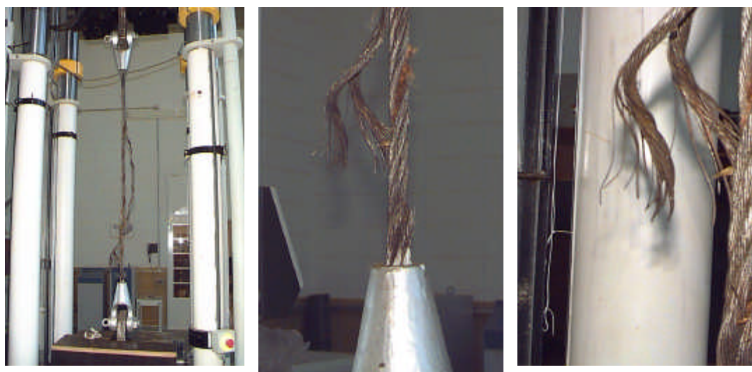
FIGURA 7.4.7: Ruptura do cabo de 1" de diâmetro.
