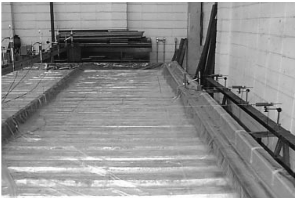
Figura 5.7: Disposição dos transdutores de deslocamento linear.
