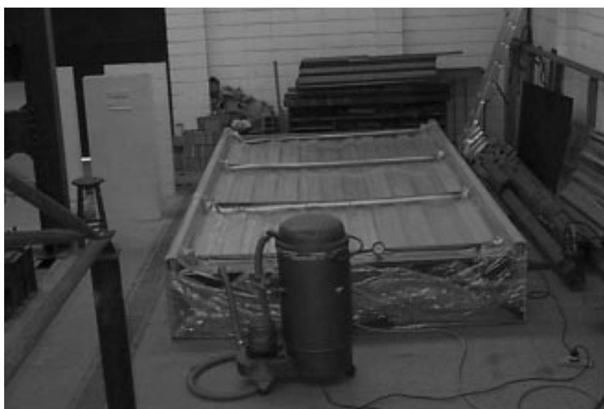
Figura 5.14: Caixa de sucção em fase de testes.
