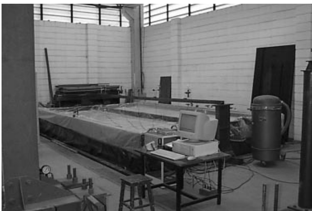
Figura 5.4: Caixa de sucção preparada para o início de um ensaio.
