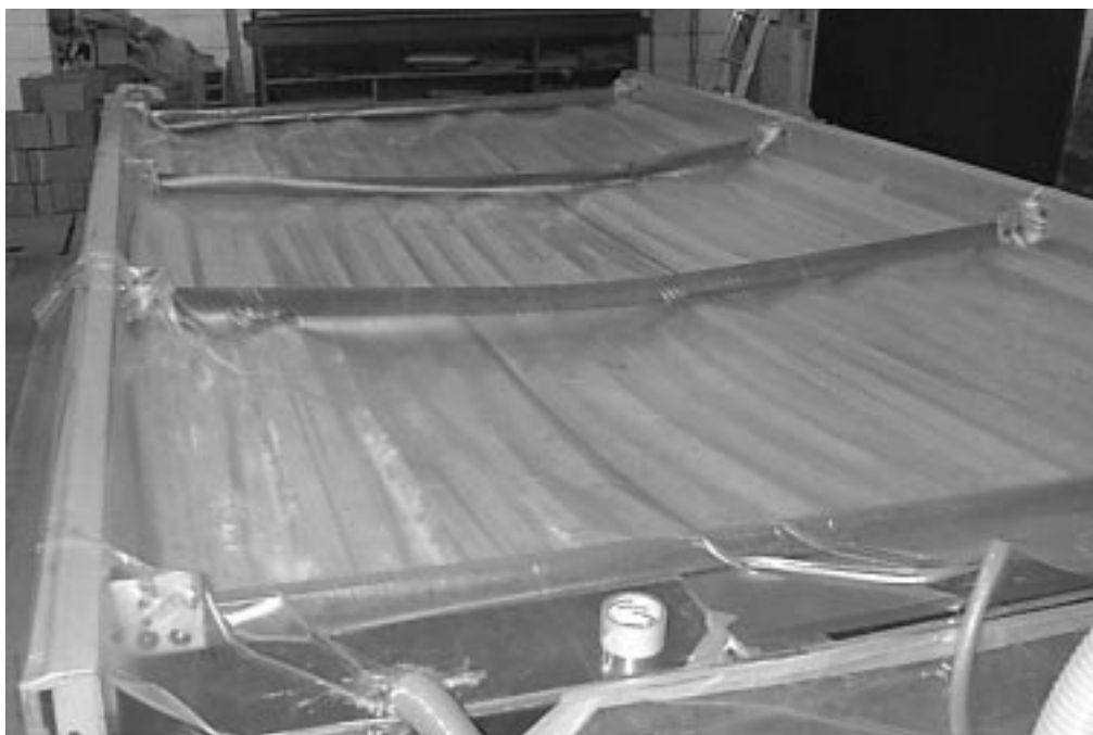
Figura 5.15: Falha do conjunto para o teste preliminar.
