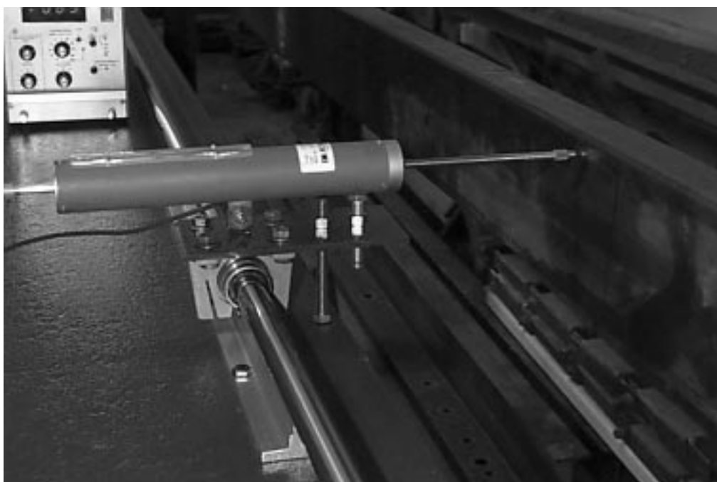
Figura 4.9: Detalhe da realização de medida da deslocada inicial do perfil.
