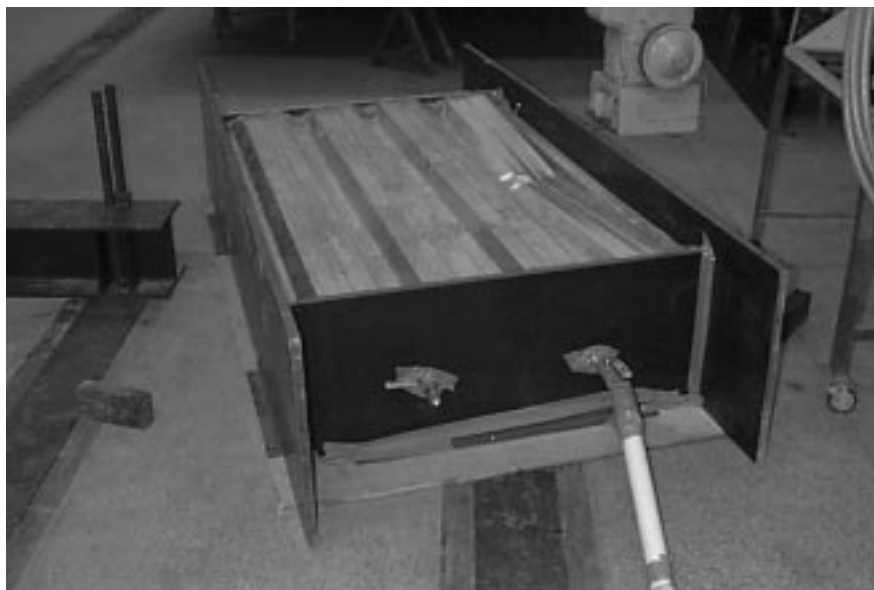
Figura 5.13: Caixa de sucção para teste em uma telha.
